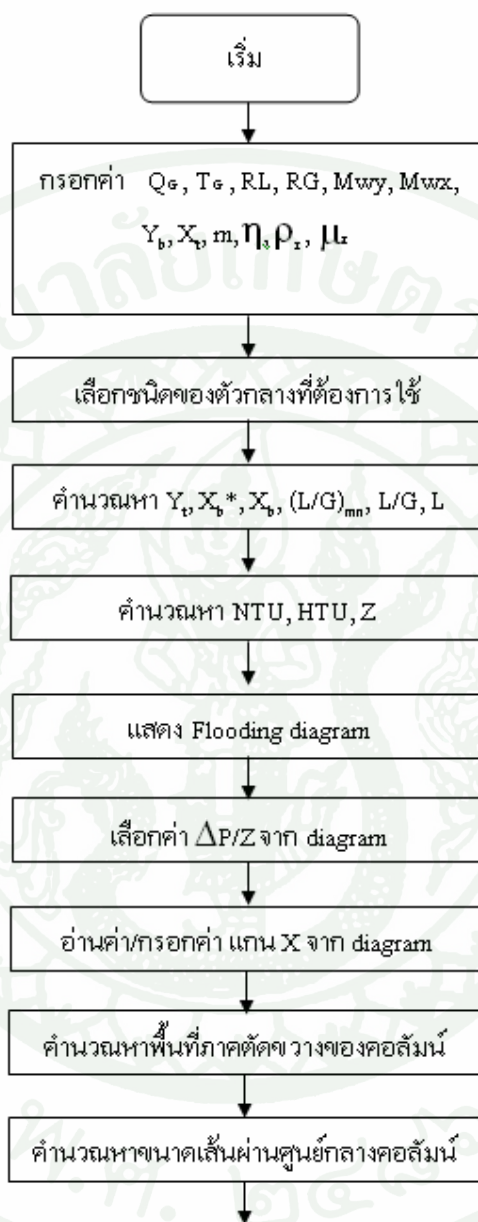
ภาพที่ 30 แผนผังการคำนวณออกแบบ Packed Bed Column เพื่อใช้ในการกำจัดก๊าซ
