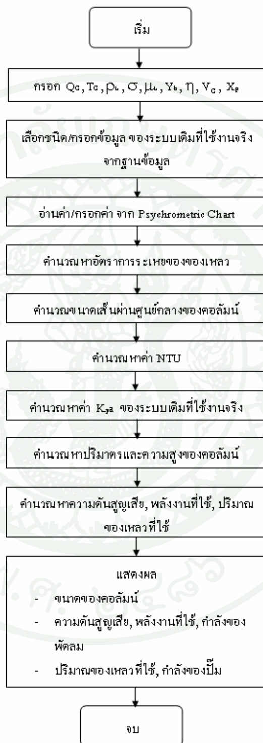
ภาพที่ 28 แผนผังการคำนวณออกแบบเวทศรับเบอร์แบบไหลสวนทางเพื่อใช้ในการกำจัดก๊าซ
