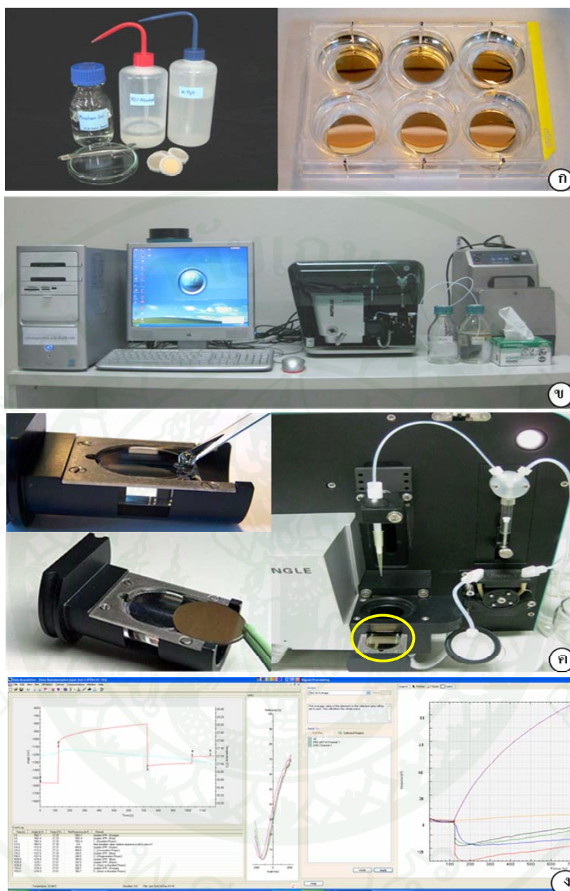
ภาพที่ 7 ขั้นตอนการทดสอบเชื้อด้วยเทคนิค SPR biosensor ก) อุปกรณ์และสารเคมีสำหรับการล้างและเคลือบแผ่นสไลด์แก้วด้วย 11 MUA ข) เครื่องมือที่ใช้ในการทดสอบ ค) การวางแผ่นสไลด์แก้วที่เคลือบอนุภาคทองคำบนปริซึมและ ง) โปรแกรมที่ใช้ในการทำปฏิกิริยา (Data acquisition version 5.1; Autolab Springle, Utrecht, The Netherlands) และ โปรแกรมการประมวลผลการทำปฏิกิริยา (Kinetic Evaluation version 5.1; (Autolab Springle, Utrecht, The Netherlands)
