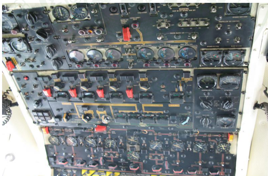
ภาพผนวกที่ 14 ระบบไฟฟ้าและเชื้อเพลิง ในห้องนักบิน เครื่องบิน C-130H กองทัพอากาศ
