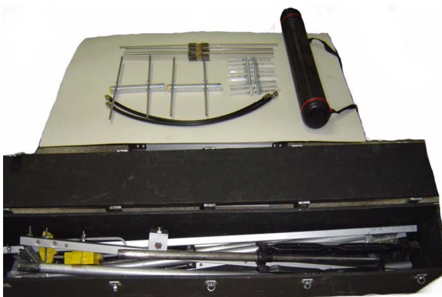
รูปที่ ๙ แสดงรูปกล่องเก็บอุปกรณ์สายอากาศและสายทำสัญญาณ
