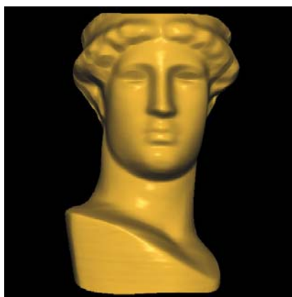
รูปที่ 2.3 แสดงตัวอย่างผลของ Laser Range Scanner
