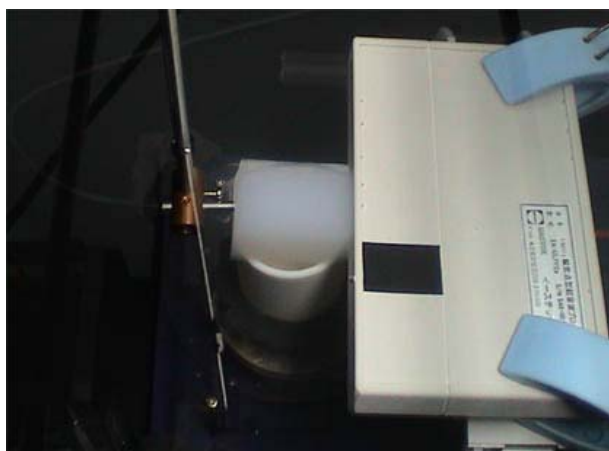
รูปที่ 5.11 การหาค่าดัชนีหักเหของแผ่นทอมจากเจลลาตินสี่เหลี่ยมที่สร้างขึ้นจากสารเดียวกัน
