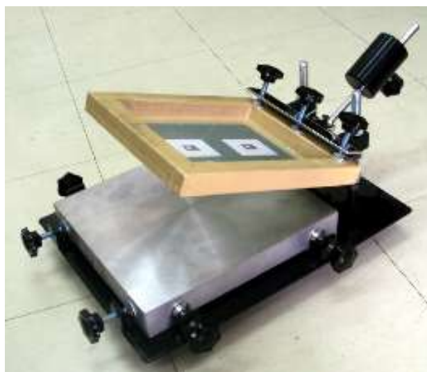
รูปที่ 2.4 บล็อกพิมพ์สกรีนติดตั้งเข้ากับแท่นพิมพ์สกรีน
