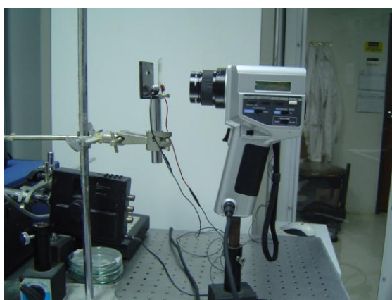
รูปที่ 3.20 ระบบตรวจวัดสมบัติทางแสงที่ใช้ในการหาค่าความสัมพันธ์ระหว่างความสว่างของไดโอดเปล่งแสงและความต่างศักย์ที่จ่ายให้กับตัวไดโอดเปล่งแสง
