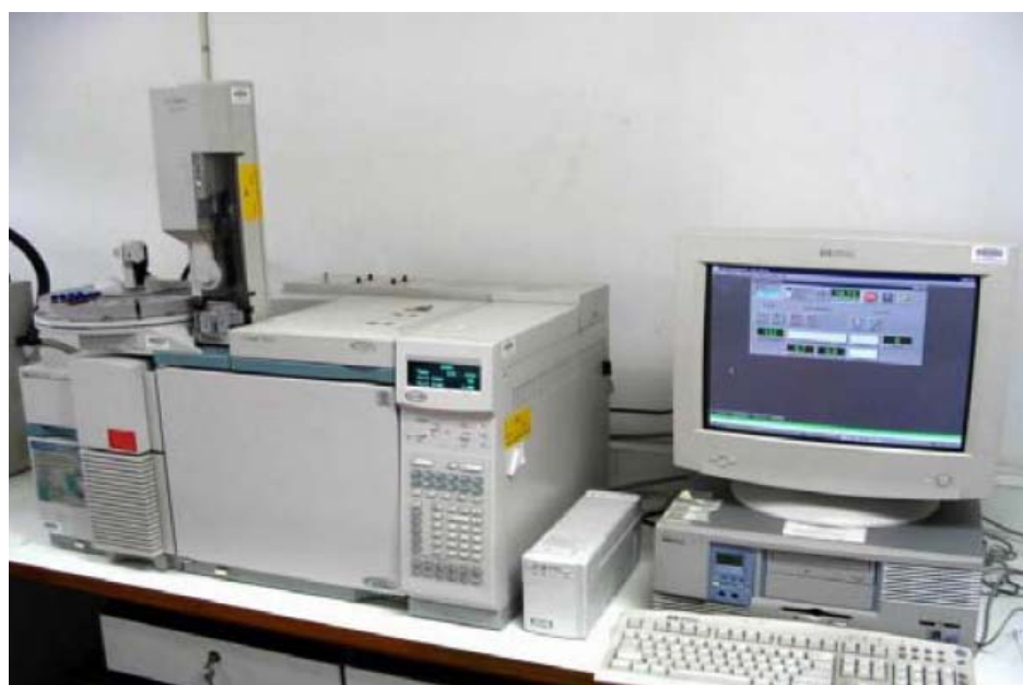
ภาพที่ 11 GC ต่อกับ Mass Spectrometer และ auto samplers
