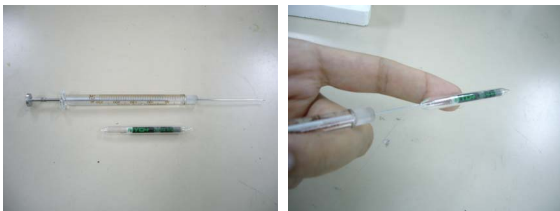
ภาพที่ 10 การวิเคราะห์ด้วยวิธีฉีดสารละลายมาตรฐานด้วย Micro syringe เข้าไปในหลอด active gas tube ที่ภายในบรรจุตัวดูดซับชนิดถ่านกัมมันต์ ที่สนใจ
