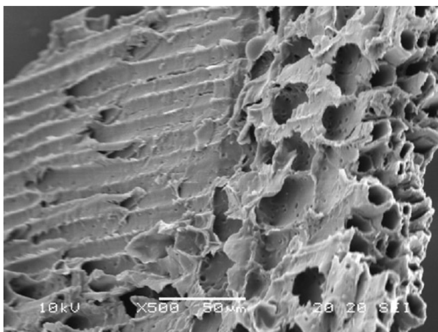
ภาพที่ 13 ลักษณะพื้นผิวภายนอกชุดการทดลอง ข ตัวดูดซับชนิดถ่านกัมมันต์ จากเศษไม้ยางพารา ทำการเผาที่อุณหภูมิ 450 องศาเซลเซียส 90 นาที ด้วยกล้องจุลทรรศน์อิเล็กตรอนชนิดส่องกราด (SEM) ที่กำลังขยาย X500 เท่า
