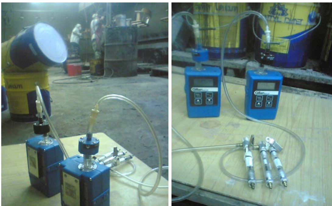
ภาพที่ 7 ชุดเก็บตัวอย่างแบบ active sampler
