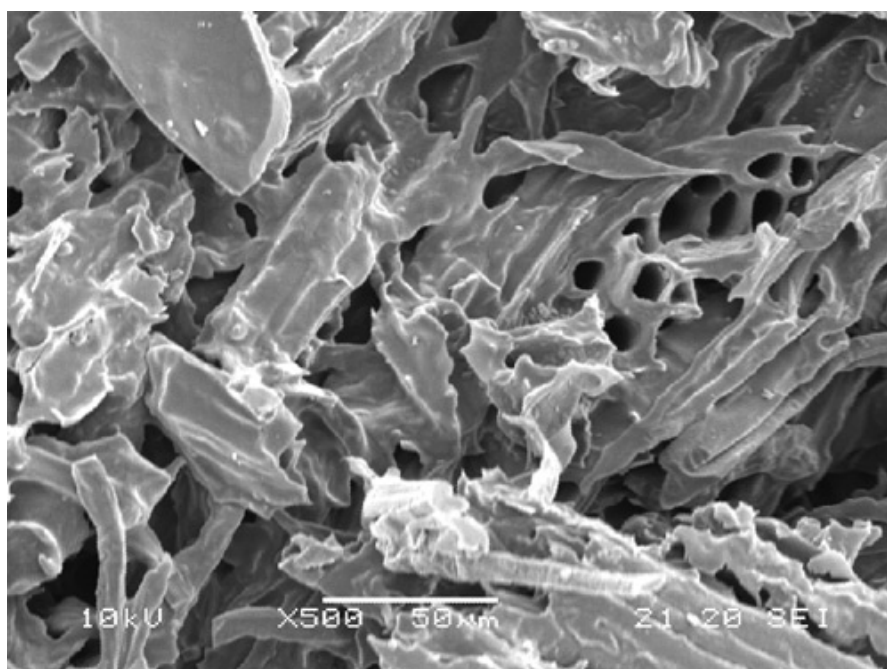
ภาพที่ 17 ลักษณะพื้นผิวภายนอกชุดการทดลอง ข ตัวดูดซับชนิดถ่านกัมมันต์ จากเศษไม้ยางพารา ทำการเผาที่อุณหภูมิ 550 องศาเซลเซียส 120 นาที ด้วยกล้องจุลทรรศน์อิเล็กตรอนชนิดส่องกราด (SEM) ที่กำลังขยาย X500 เท่า
