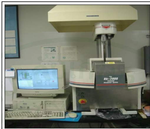
ภาพที่ 50 เครื่อง Capillary Rheometer มาตรฐานการทดสอบ: ASTM D 5099
