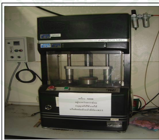
ภาพที่ 51 เครื่อง Moving Die Rheometer มาตรฐานการทดสอบ: ASTM D 5289
