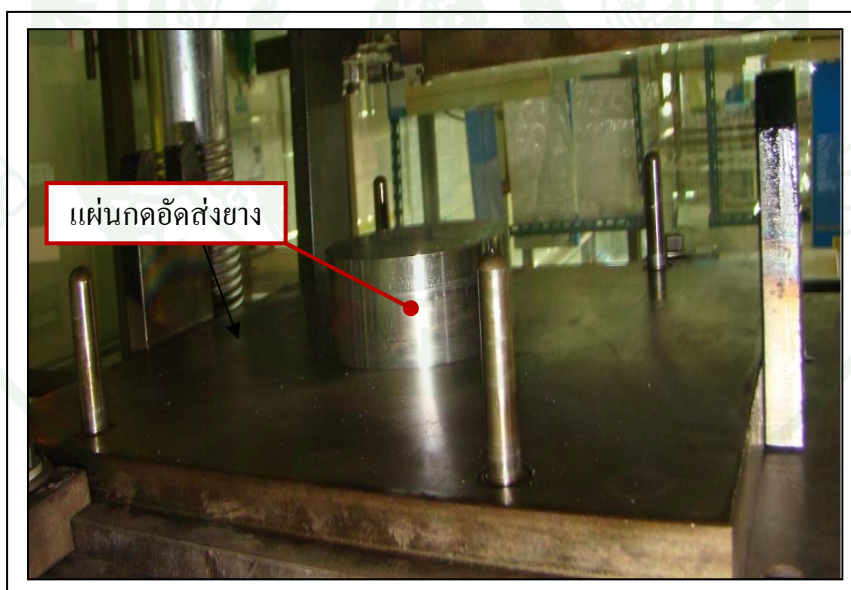
ภาพที่ 89 ลักษณะแม่พิมพ์แผ่นบนที่ได้จากกระบวนการผลิตแม่พิมพ์
