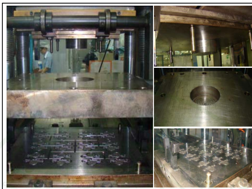
ภาพที่ 104 แม่พิมพ์อัดส่งขึ้นรูปผลิตภัณฑ์ยางปุ่มกดในกลึงถ่ารูปที่ได้จากการผลิต
