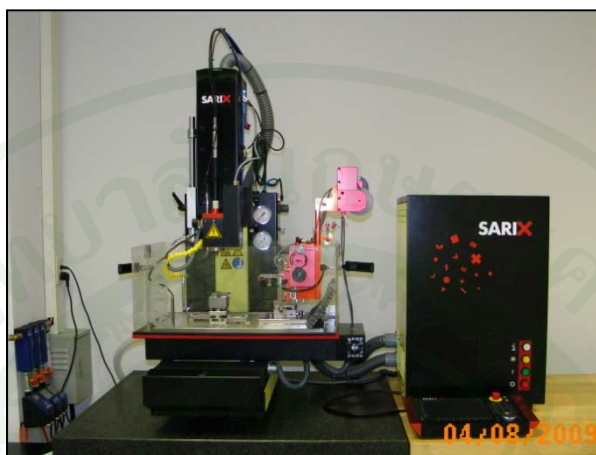
ภาพที่ 1 ตัวอย่างเครื่องกัดเซาะโลหะด้วยกระแสไฟฟ้าในงานความละเอียดสูง (Micro EDM)
