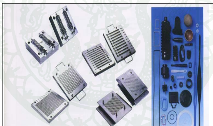
ภาพที่ 12 ตัวอย่างแม่พิมพ์ยางแบบอัดขึ้นรูป
