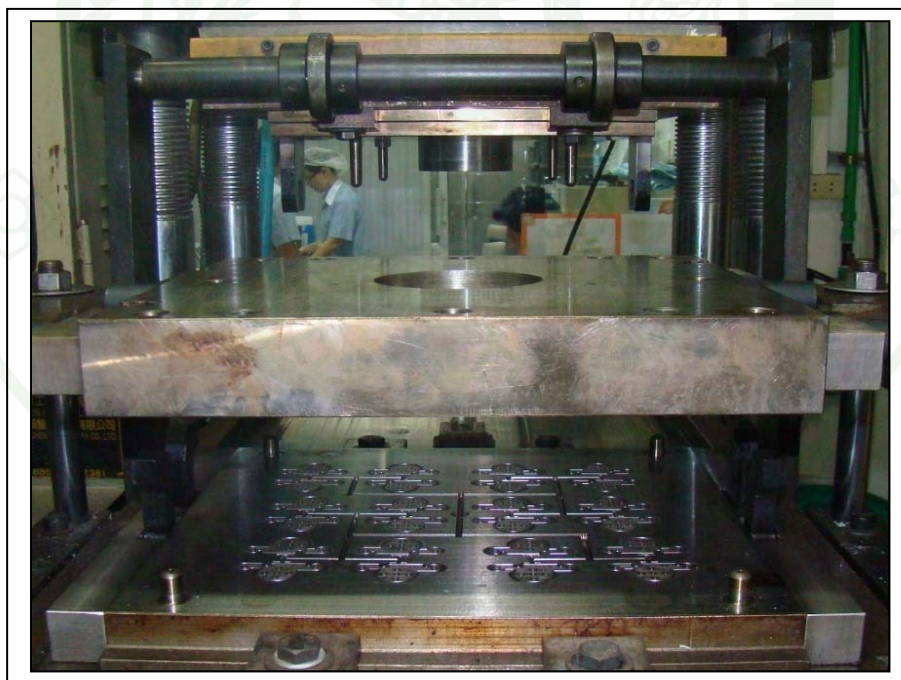
ภาพที่ 93 ลักษณะแม่พิมพ์อัดส่งขึ้นรูปผลิตภัณฑ์ที่สมบูรณ์ที่ได้จากกระบวนการผลิตแม่พิมพ์
