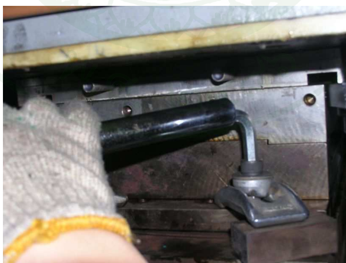
ภาพที่ 105 การยึดแม่พิมพ์บนเครื่องอัด
