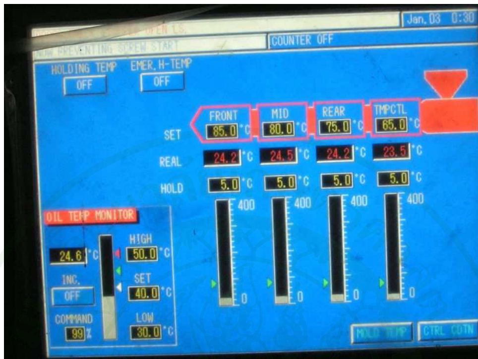
ภาพที่ 98 หน้าจอกำหนดค่าอุณหภูมิกระบอกฉีด
