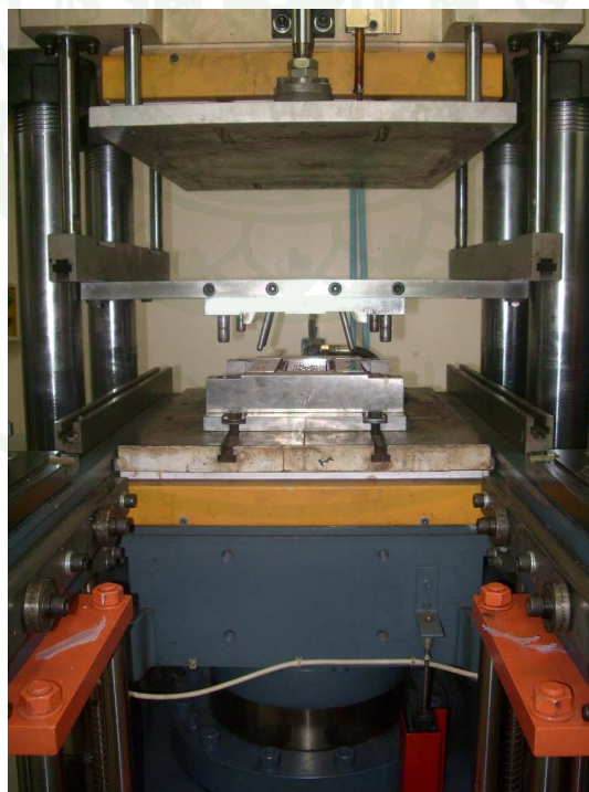
ภาพที่ 91 แม่พิมพ์ที่ติดตั้งเสร็จแล้ว
