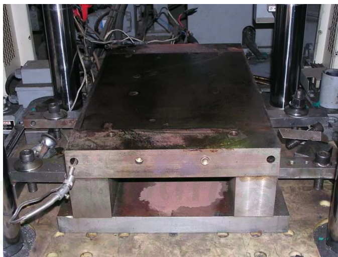
ภาพที่ 96 ส่วนฐานรองแม่พิมพ์สำหรับยึดแม่พิมพ์และใส่แท่งให้ความร้อน
