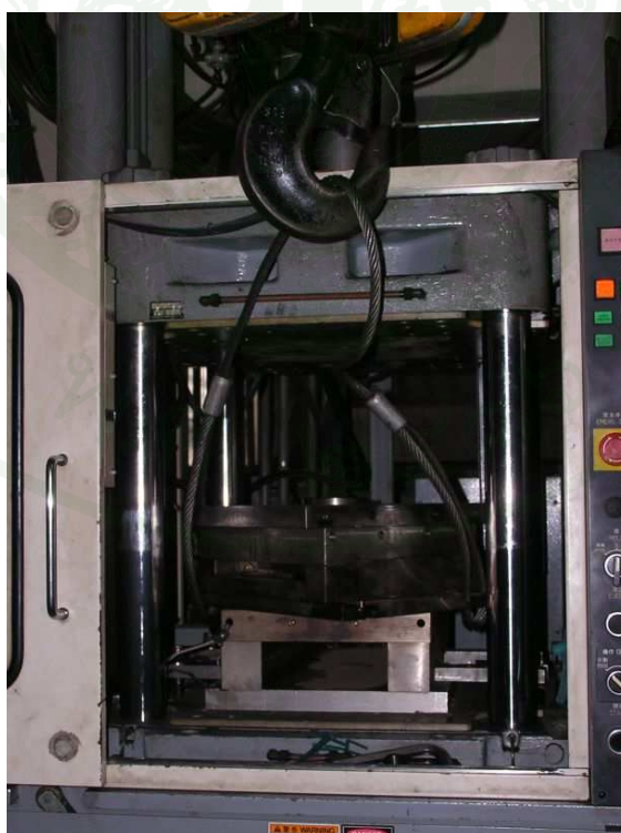
ภาพที่ 103 ขั้นตอนการติดตั้งแม่พิมพ์
