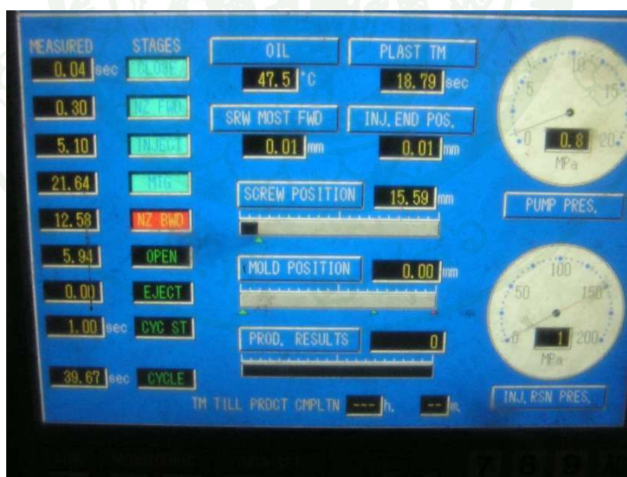
ภาพที่ 101 หน้าจอแสดงข้อมูลจริงขณะทำการฉีดขึ้นรูป
