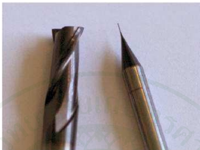
ภาพที่ 11 ดอกกัดชิ้นงานทั่วไปขนาด 6 มม. เทียบกับดอกกัดชิ้นงานขนาด 200 ไมโครเมตร
