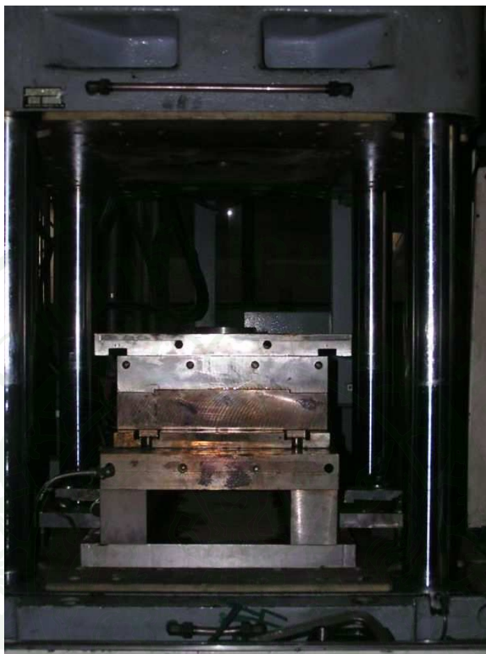
ภาพที่ 104 การติดตั้งแม่พิมพ์บนเครื่องอัด
