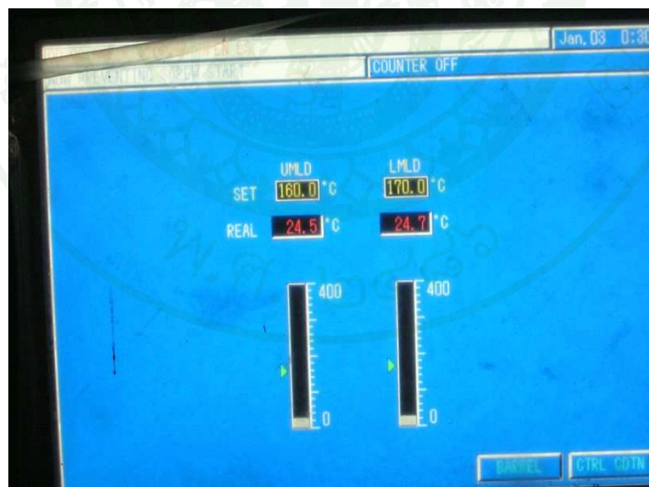
ภาพที่ 99 หน้าจอกำหนดค่าอุณหภูมิแม่พิมพ์
