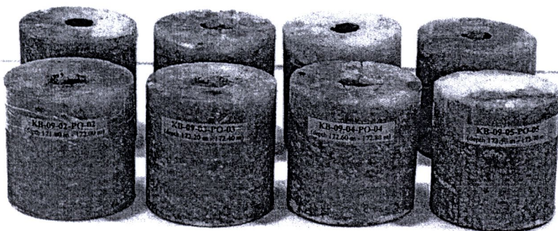
รูปที่ 6.12 ตัวอย่างเกลียวหินหลังการทดสอบ Push-out
