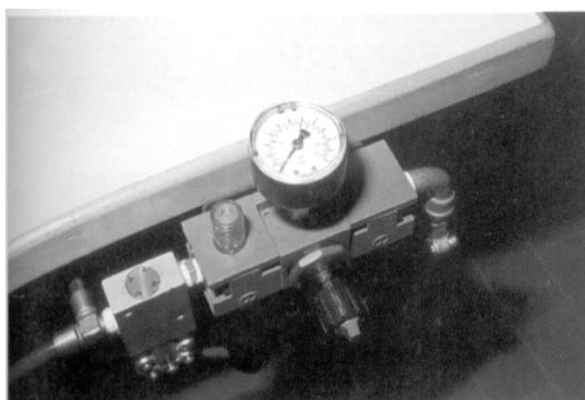
ภาพที่ 2.6 Manometer gauge สำหรับวัดค่าแรงดันลมในการยิงผ้า
