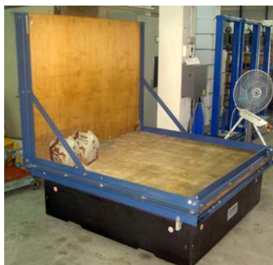
ภาพที่ 4.25 ทดสอบโดยใช้เครื่อง การต้านแรงสั่นสะเทือน
