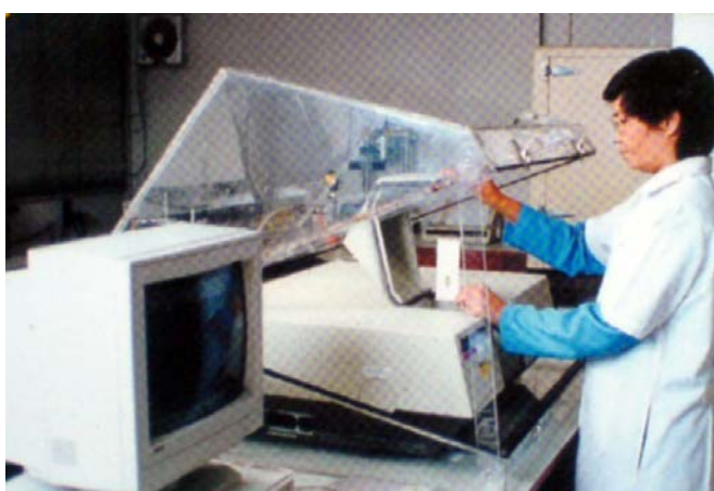
ภาพที่ 4.31 การทดสอบอัตราการซึมผ่านของก๊าซออกซิเจน
