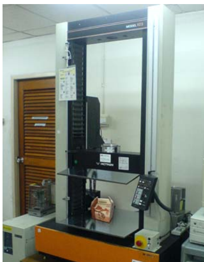
ภาพที่ 4.26 การทดสอบประสิทธิภาพในด้านความต้านแรงกดโดยใช้เครื่อง Instron
