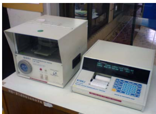
ภาพที่ 4.31 ทดสอบอัตราการซึมผ่านของก๊าซออกซิเจน โดยใช้เครื่อง Oxygen permeation tester
