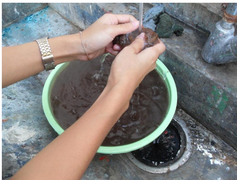
ภาพที่ 4.10 ลักษณะของเยื่อที่ล้างน้ำเปล่าก่อนการนำไปปั่นละเอียด
