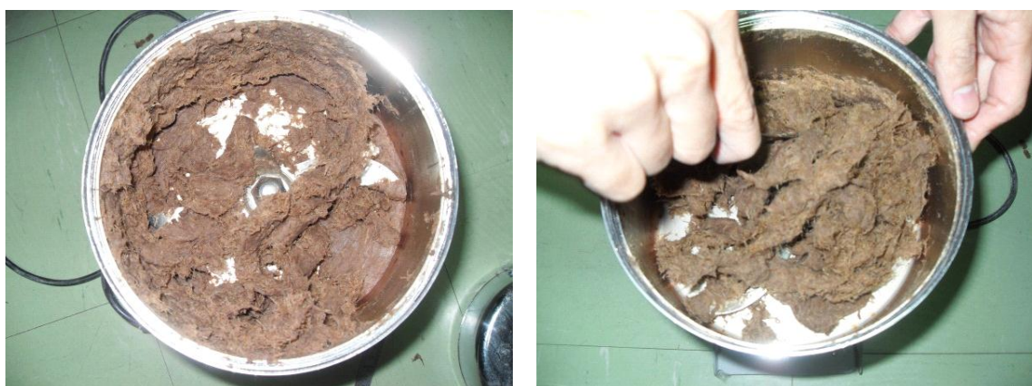
ภาพที่ 4.13 ขั้นตอนการปั่นเยื่อโดยเครื่องปั่นเยื่อกระดาษในระบบอุตสาหกรรม
