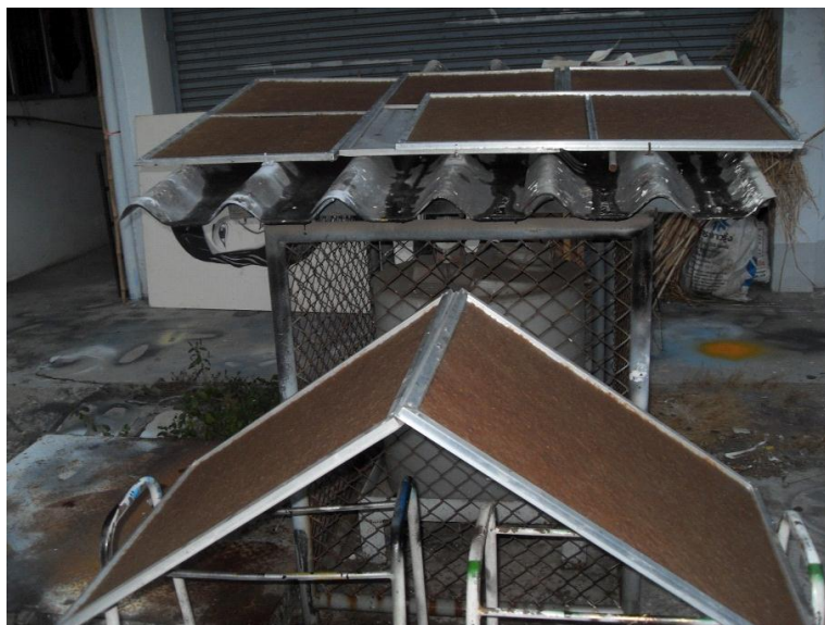
ภาพที่ 4.19 ขั้นตอนการผึ่งและตากแดดแผ่นกระดาษจากเยื่อไม้ที่ได้ให้แห้งระยะเวลา 1 วัน
