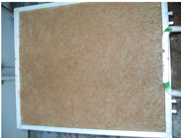
ภาพที่ 4.18 ลักษณะของแผ่นที่ร่อนเยื่อติดบนตะแกรงร่อนเยื่อแล้ว
