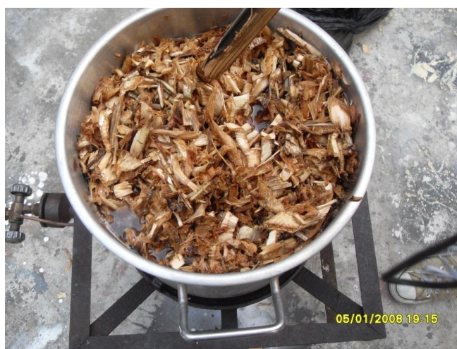
ภาพที่ 4.6 ลักษณะของเยื่อลำต้นวัชพืชที่ตากแห้งแล้วนำมาต้มในน้ำเปล่าร่วมกับโซดาไฟ
