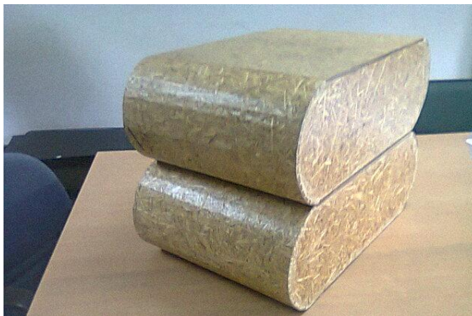
ภาพที่ 4.32 การขึ้นรูปเก้าอี้นั่งเล่นขนาดเล็กในบ้านพักอาศัยจากเศษวัสดุไม้ในนาข้าวภาคกลาง
