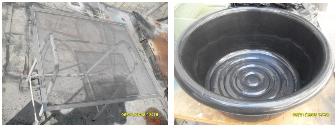
ภาพที่ 4.14 อุปกรณ์ตะแกรงร้อนเยื่อกระดาษและกะละมังสำหรับร้อนเยื่อเศษวัชพืชในนาข้าว
