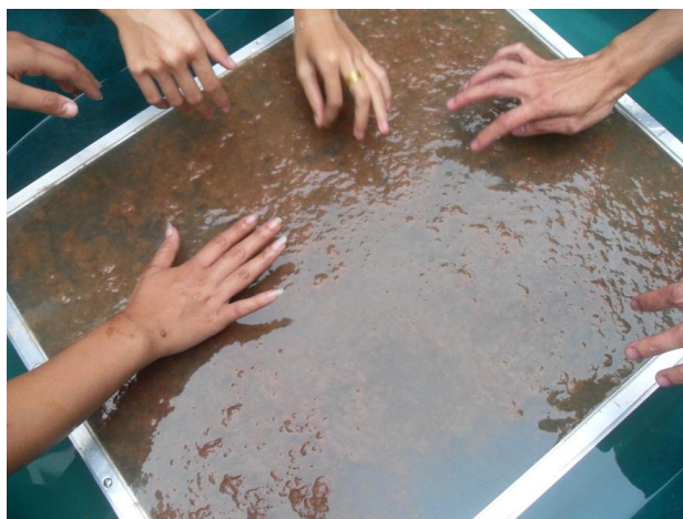
ภาพที่ 4.16 ขั้นตอนการขึ้นรูปแบบแผ่นโดยการละลายเยื่อกล้วยไข่ลงในตะแกรงร่อนเยื่อ
