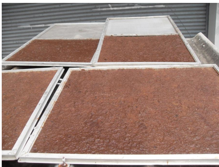
ภาพที่ 4.20 การตากแผ่นเยื่อกระดาษที่ได้จากการร่อนโดยใช้เวลาการตากแดดที่ระยะเวลา 1 วัน
