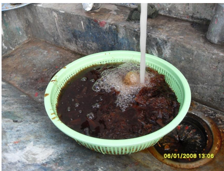
ภาพที่ 4.9 ขั้นตอนการล้างเยื่อที่ผ่านการต้มด้วยน้ำเปล่าแล้ว
