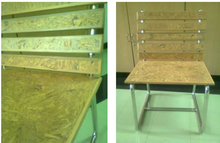
ภาพที่ 4.12 แสดงการเข้ากรอบชิ้นงานแผ่นวัสดุทดแทนไม้ที่จะต้องปิดขอบชิ้นงาน
