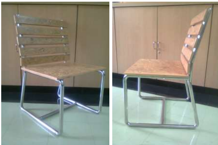
ภาพที่ 4.9 แสดงชิ้นงานเก้าอี้พักผ่อนสำหรับบ้านพักอาศัยจากยอดและใบอ้อย
