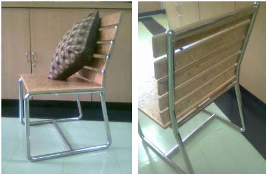
ภาพที่ 4.11 แสดงการยึดติดด้วยตะปูเกลียวด้านหลังเพื่อยึดชิ้นงานกับโครงสร้างสแตนเลส
