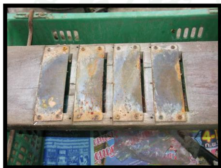
เครื่องไสหน่อไม้ที่ชาวบ้านดัดแปลงขึ้นมาเอง
