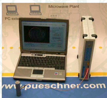
ภาพผนวกที่ ๑1 เครื่อง Network Analyser พร้อมหัววัดแบบ Open-ended coaxial probe
