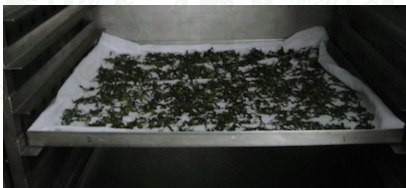
ภาพที่ 32 การเรียงใบชาในถาดสำหรับอบแห้งด้วยเครื่องอบแห้ง Tray drier
