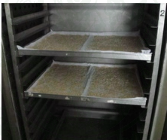
ภาพที่ 37 การจัดเรียงเมล็ดข้าวบนถาดเพื่ออบแห้งด้วย Tray drier
