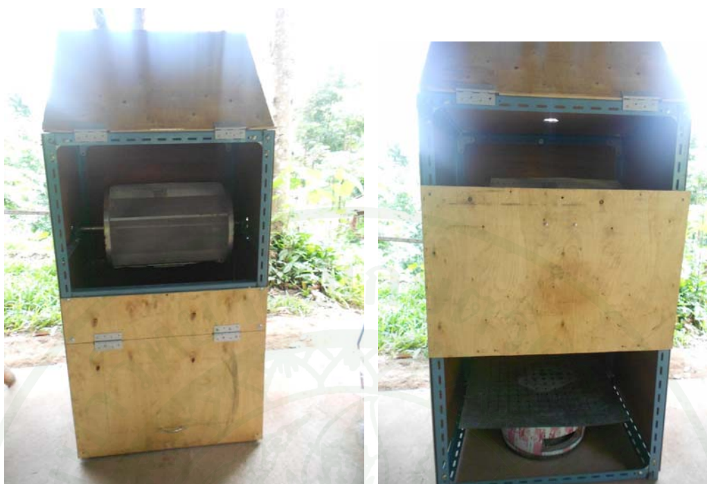
ภาพที่ 61 เครื่องกั้วแบบเตาถ่านที่ประยุกต์ใช้ในการผลิตชาเขียวระดับครัวเรือน
