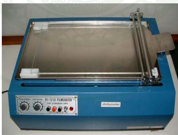
ภาพที่ 9 เครื่องเคลือบกระดาษ (Film coater PI-1210)
