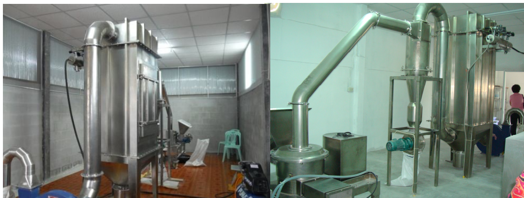
ภาพที่ 4.2.6 เครื่องบดแบ่งข้าวหอมมะลิของกลุ่มวิสาหกิจผลิตแบ่งข้าวขาวดอกมะลิ 105 บ้านเล้า
