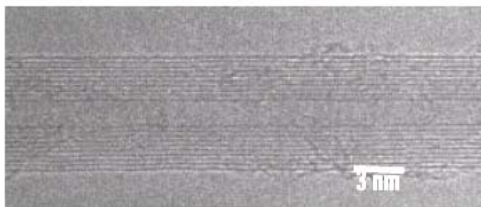
ภาพที่ 1 แสดงภาพของท่อนาโนคาร์บอนขนาดเล็กระดับนาโนเมตรที่ค้นพบโดย Iijima จากกล้องจุลทรรศน์อิเล็กตรอนแบบส่องผ่านกำลังขยายสูง ที่มา: Iijima (1991)
