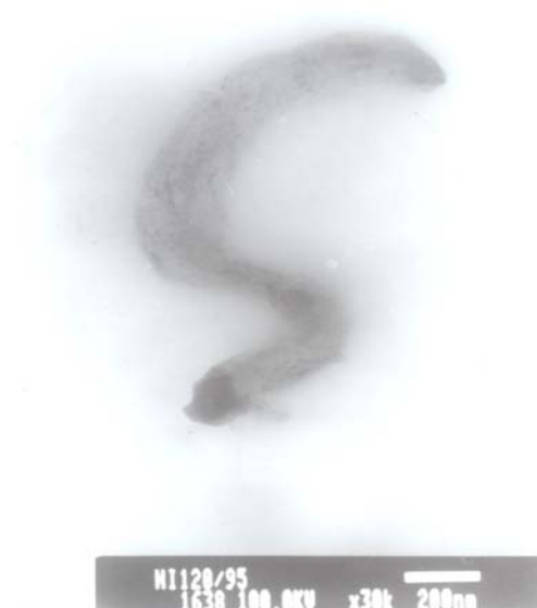
ภาพที่ 31 ภาพถ่าย TEM ของ CNTs ที่สังเคราะห์ด้วยแก๊สอะเซทิลีน ที่อัตราการไหล 120 sccm
