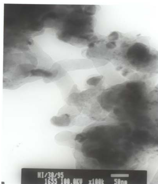
ภาพที่ 33 ภาพถ่าย TEM ของ CNTs ที่สังเคราะห์ด้วยแก๊สอะเซทิลีน ที่อัตราการไหล 30 sccm
