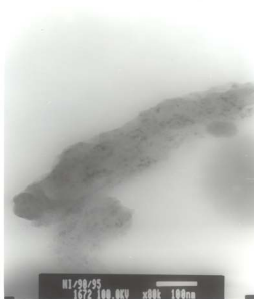
ภาพที่ 32 ภาพถ่าย TEM ของ CNTs ที่สังเคราะห์ด้วยแก๊สอะเซทิลีน ที่อัตราการไหล 90 sccm
