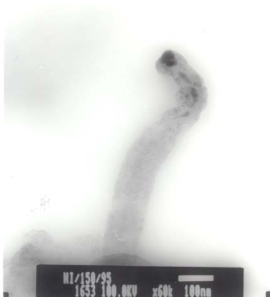
ภาพที่ 30 ภาพถ่าย TEM ของ CNTs ที่สังเคราะห์ด้วยแก๊สอะเซทิลีน ที่อัตราการไหล 150 sccm
