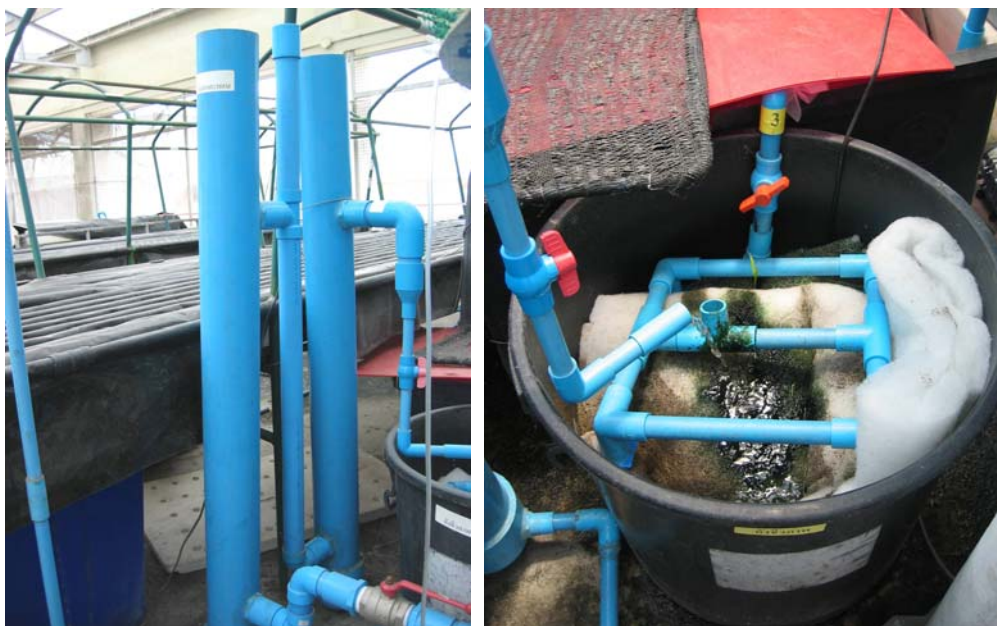
ภาพที่ 3.18 ลักษณะของถังตกตะกอน (ก) และถังชีวภาพ (ข) ของระบบการเลี้ยงปลาแบบทิม
