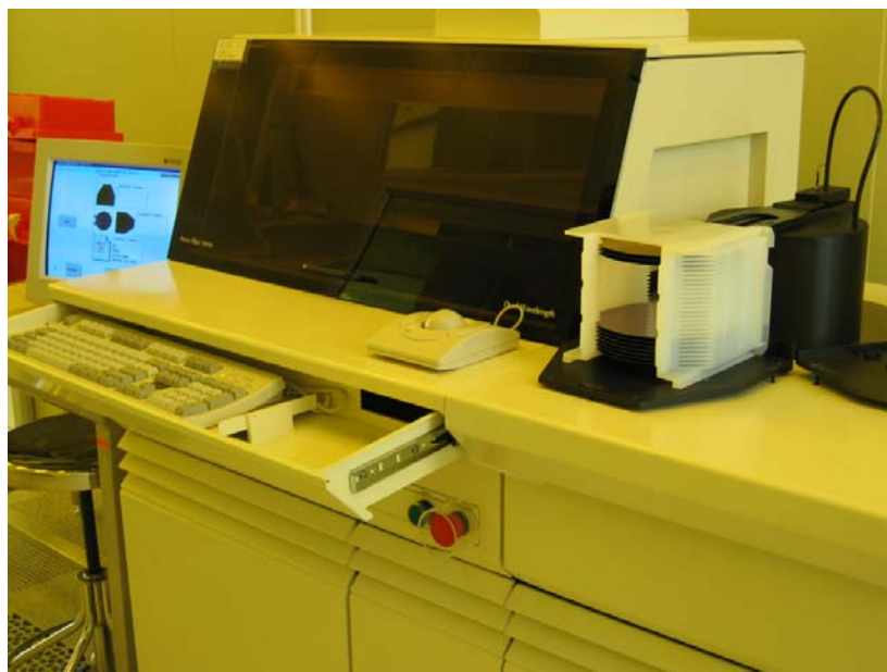
รูปที่ 3.4 เครื่องอิตลิปโซมิเตอร์ รุ่น Rudolph FEIII
