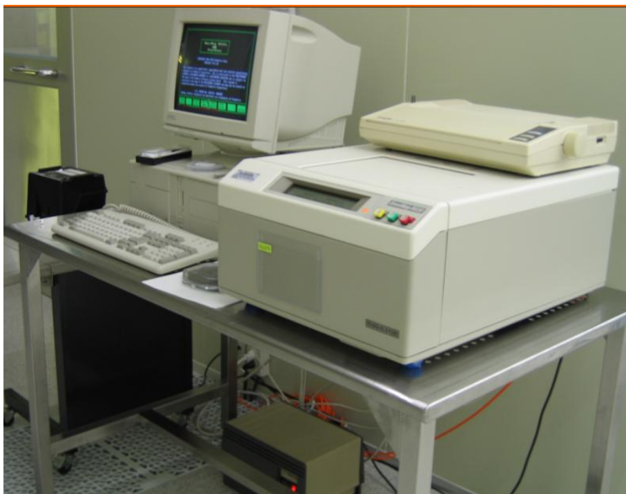
รูปที่ 3.6 เครื่องโพรมิเท็กซ์โพรบรุ่น Prometrix Rs-30
