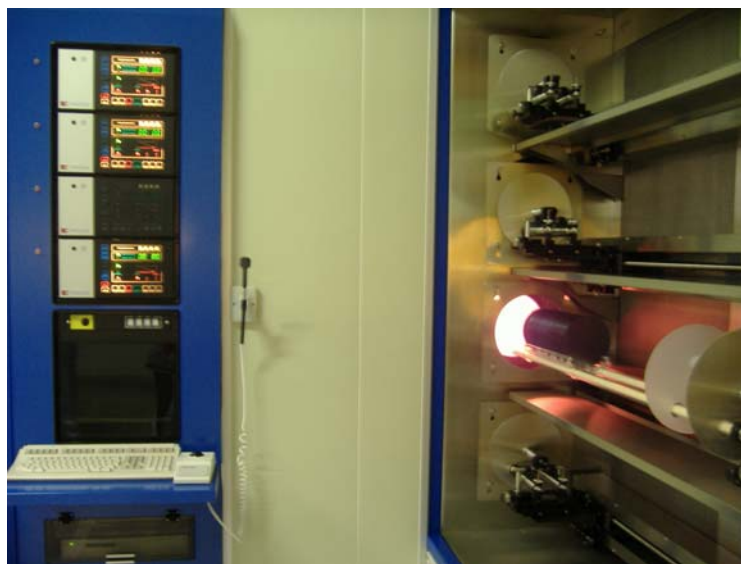
รูปที่ 2.14 เตาแอนนิลแบบแนวนอน ที่ศูนย์เทคโนโลยีไมโครอิเล็กทรอนิกส์
