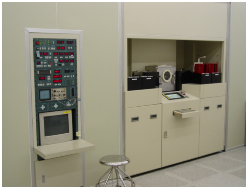
รูปที่ 2.12 เครื่องยิงฟองประจุรุ่น NH-20SR ที่ศูนย์เทคโนโลยีไมโครอิเล็กทรอนิกส์
