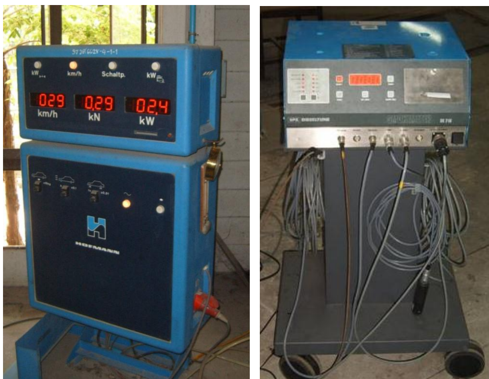
รูปที่ 4.8 แสดงชุดควบคุมกำลัง ความเร็วของเครื่องยนต์และเครื่องวัดปริมาณควันท่อไอเสีย
