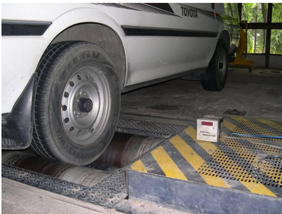
รูปที่ 4.9 แสดงชุดควบคุมกำลัง ความเร็วของเครื่องยนต์ และเครื่องวัดปริมาณควันท่อไอเสีย
