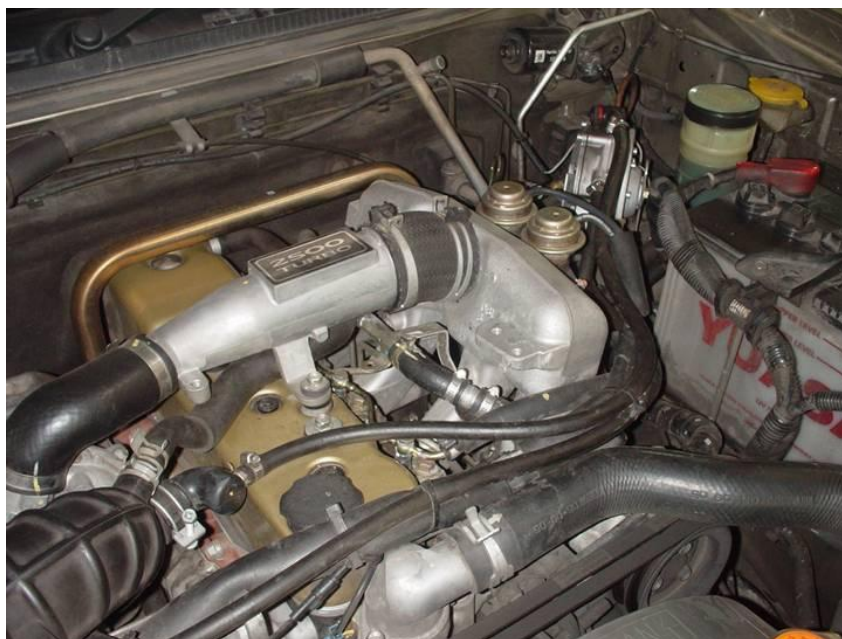
รูปที่ 4.13 การติดตั้งระบบสายส่งแก๊สของ Isuzu D-max 2500 cc Engine
