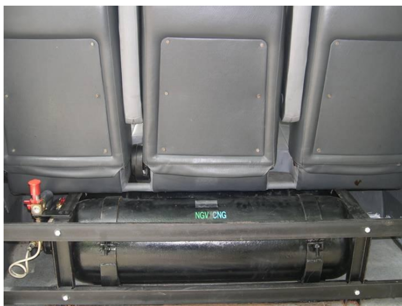
รูปที่ 4.5 แสดงการติดตั้งถังแก๊สของรถยนต์ Toyota Hi-ace 3000 cc Engine
