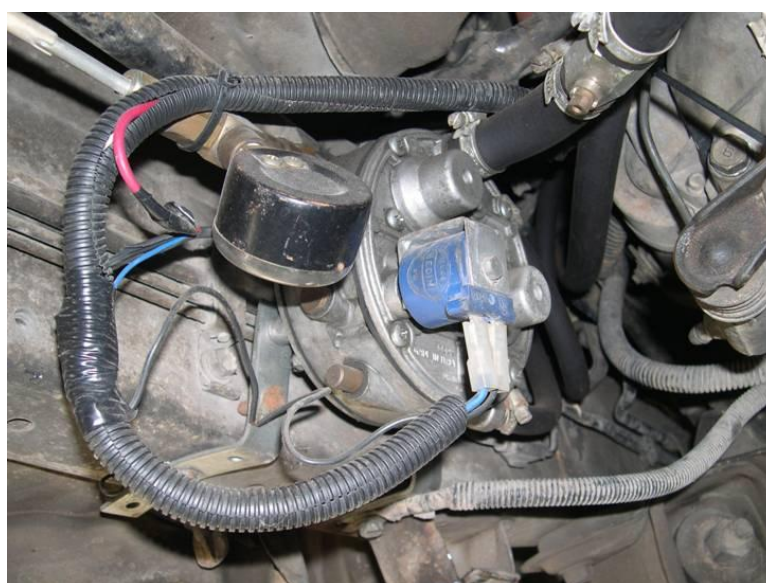
รูปที่ 4.6 การติดตั้งระบบลดความดันแก๊ส Pressure Regulator of Toyota Hi-ace 3000 cc Engine
