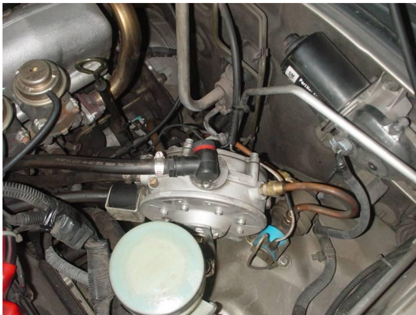
รูปที่ 4.12 การติดตั้งระบบลดความดันแก๊ส Pressure Regulator of Isuzu D-max 2500 cc Engine
