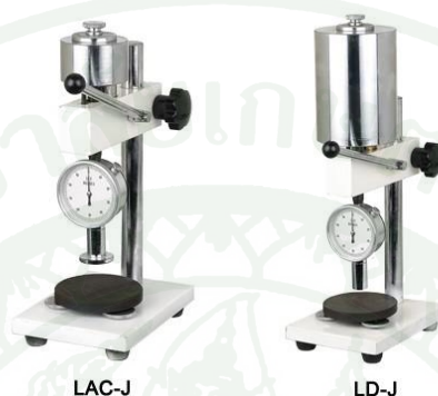
ภาพที่ 19 แสดงเครื่องทดสอบความแข็ง (Hardness meter)
