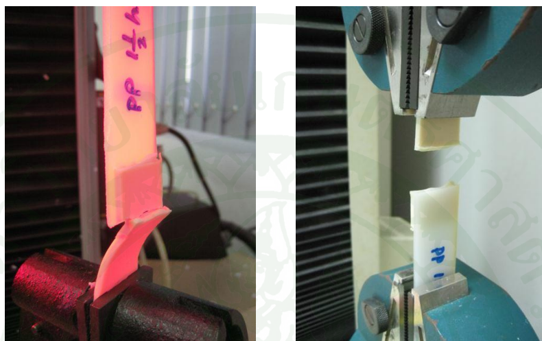
ภาพที่ 84 การทดสอบความต้านทานต่อแรงเฉือนระหว่าง PP และ SAN™ ที่เกิดการขาดที่บริเวณชิ้นงานของ SAN™
