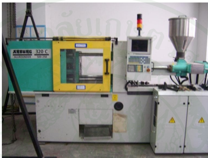
ภาพที่ 26 เครื่องฉีดขึ้นรูป (Injection molding machine) ที่ใช้เตรียมชิ้นงาน
