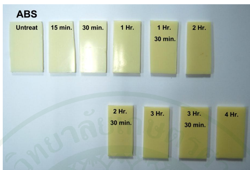
ภาพที่ 75 พื้นผิว ABS ก่อนและหลังการฉายรังสีอัลตราไวโอเลตตามระยะเวลาที่กำหนด
