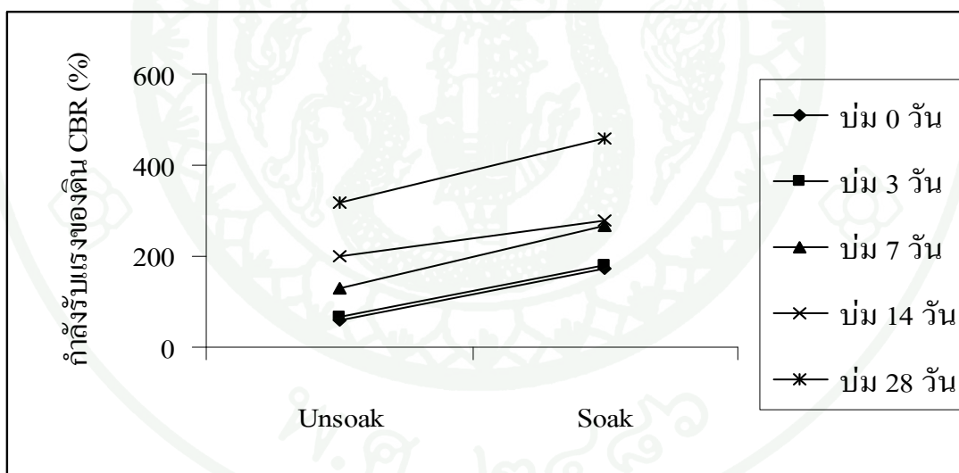
ภาพที่ 38 กำลังรับแรงระหว่าง Unsoak CBR และ Soak CBR ของดินลูกรังผสมเกรด D ผสมสารผสมเพิ่ม 25% ที่ระยะการบ่มต่างๆ
