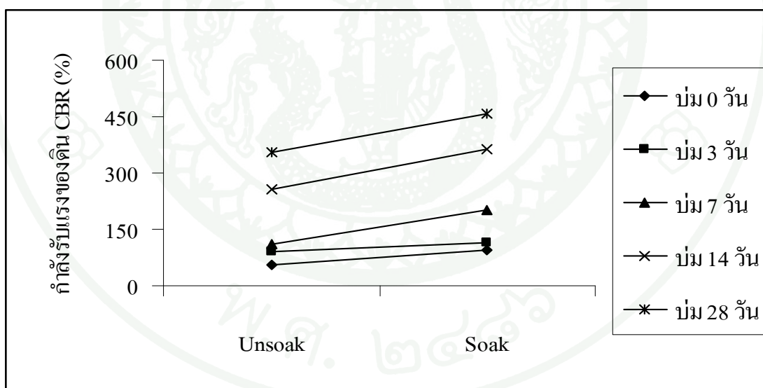
ภาพที่ 32 กำลังรับแรงระหว่าง Unsoak CBR และ Soak CBR ของดินลูกรังผสมเกรด B ผสมสารผสมเพิ่ม 10% ที่ระยะการบ่มต่างๆ
