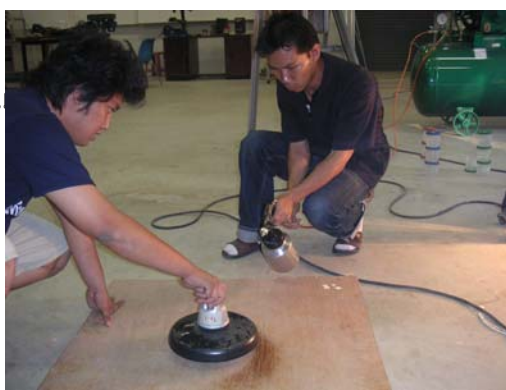
รูปที่ 3.21 การอบลูกถ้วยฉนวนเพื่อให้พื้นผิวของลูกถ้วยฉนวนแห้ง
