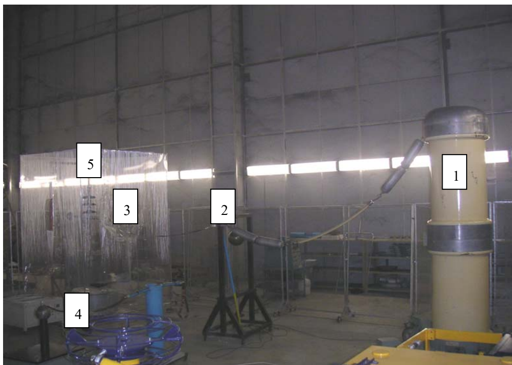
รูปที่ 3.24 วงจรการทดสอบภายใต้เงื่อนไขการทดสอบกระแสตรง ผลการทดสอบปรากฏการณ์โคโรนาของลูกถ้วยฉนวนที่ระดับความเปราะเปื้อนต่างๆ ดังแสดงในตารางที่ 3.10
