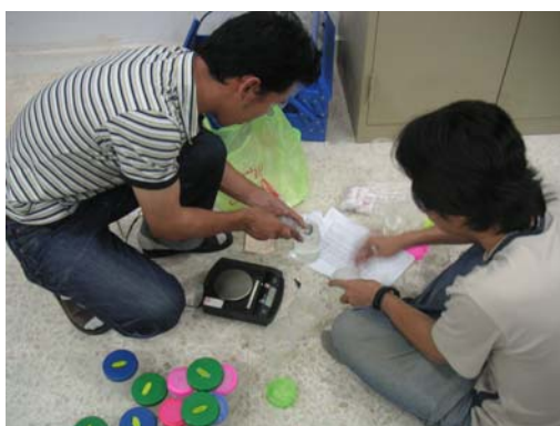
รูปที่ 3.19 การเตรียมสิ่งประเอื้อนหรือ ESDD ที่ระดับความประเอื้อนสูง
