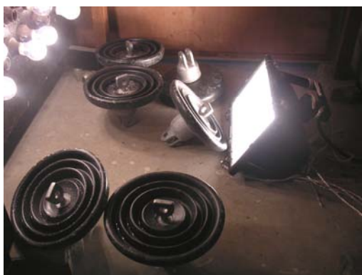
รูปที่ 3.23 การอบลูกถ้วยฉนวนเพื่อให้พื้นผิวของลูกถ้วยฉนวนแห้งหลังจากพ่นสิ่งประกอบเปื้อนจำลอง ขั้นตอนการทดสอบ
