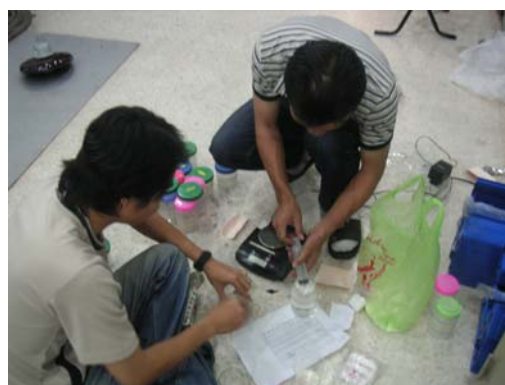
รูปที่ 3.19 การเตรียมสิ่งประเอื้อนหรือ ESDD ที่ระดับความประเอื้อนสูง
