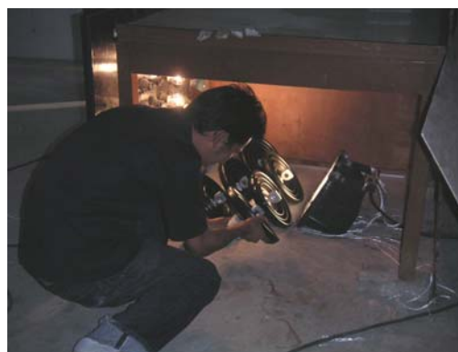
รูปที่ 3.23 การอบลูกถ้วยฉนวนเพื่อให้พื้นผิวของลูกถ้วยฉนวนแห้งหลังจากพ่นสิ่งประกอบเปื้อนจำลอง ขั้นตอนการทดสอบ
