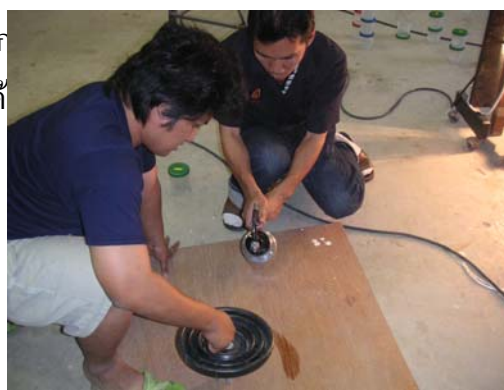
รูปที่ 3.21 การอบลูกถ้วยฉนวนเพื่อให้พื้นผิวของลูกถ้วยฉนวนแห้ง
