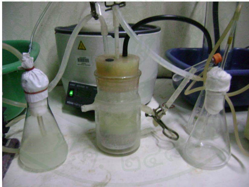
ภาพที่ 9 ถังหมักสำหรับผลิตก๊าซไฮโดรเจนโดยเซลล์ตรึง
