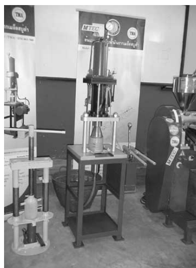
ภาพที่ 4 เครื่องหีบน้ำมันสบูดำด้วยระบบไฮดรอลิก ที่มา: สำนักงานอุตสาหกรรมจังหวัดหนองบัวลำภู (2549)
