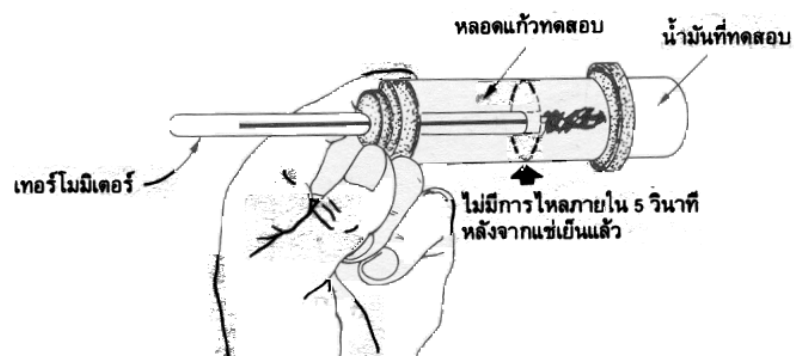
ภาพที่ 20 แสดงวิธีการทดสอบจุดไหลเทของไบโอดีเซล
