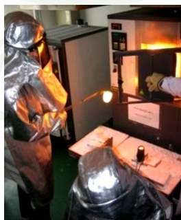
ภาพที่ 7 ขณะเทน้ำแก้วลงแม่พิมพ์คาร์บอน เพื่อทำแท่งแก้วใส
