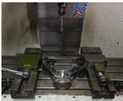
ภาพที่ 40 การกัดชิ้นงานด้วยเครื่อง CNC ที่ควบคุมด้วยระบบ CAD/CAM
