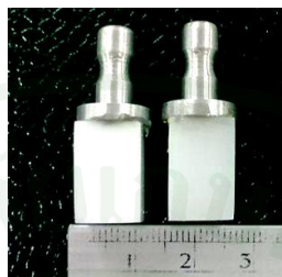
ภาพที่ 9 ชิ้นงานกลาสเซรามิกหลังการติดกับฐาน โลหะสำหรับการขึ้นรูปด้วย CAD/CAM
