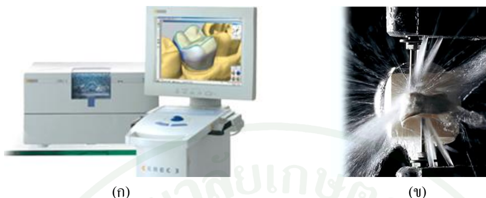
ภาพที่ 4 (ก) การออกแบบวัสดุทางทันตกรรมด้วยคอมพิวเตอร์ (CAD) (ข) การขึ้นรูปวัสดุทางทันตกรรมด้วย CAM
