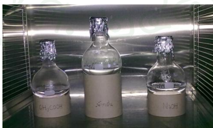
ภาพที่ 23 การทดสอบการละลายทางเคมีของกลาสเซรามิก
