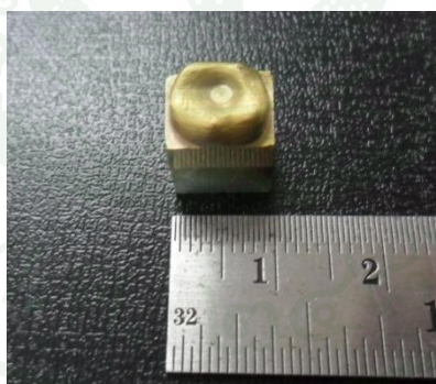
ภาพที่ 42 กลาสเซรามิกที่ขึ้นรูปเป็นวัสดุทางทันตกรรมหลังจากการเคลือบด้วยทอง (Gold sputtering)
