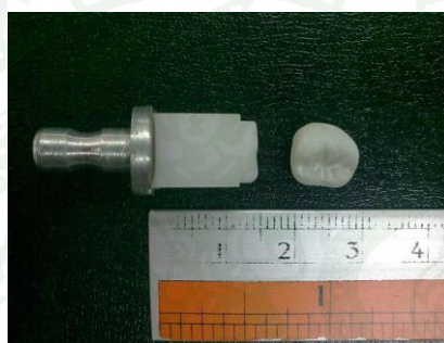
ภาพที่ 41 กลาสเซรามิกหลังจากการขึ้นรูปด้วยเครื่อง CNC
