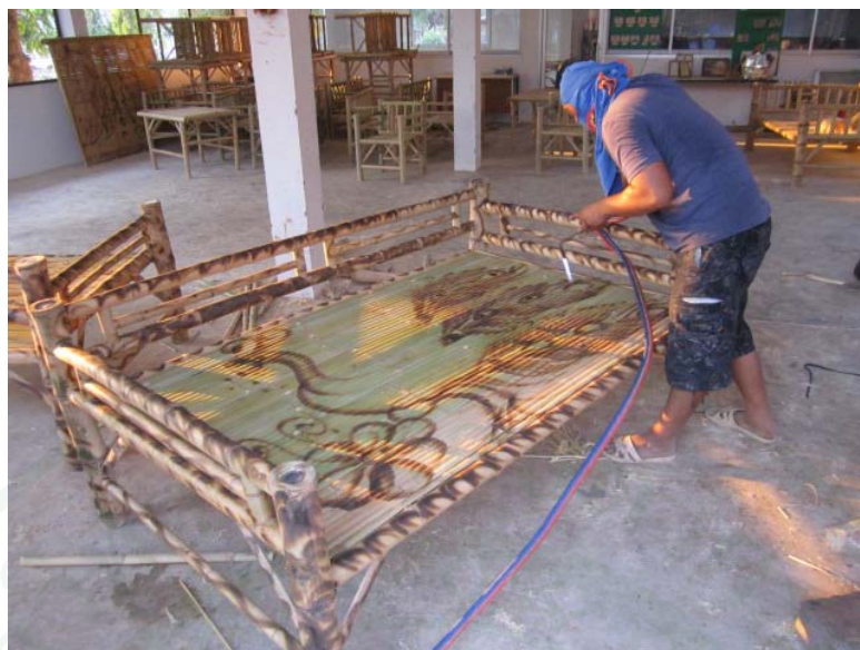
ภาพผนวกที่ 17 การสร้างลวดลายโดยใช้แก๊ส ที่มา: จากการสำรวจ
