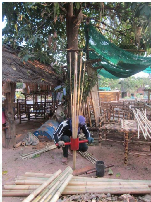
ภาพผนวกที่ 14 การผ่ารวีไม้ไผ่ด้วยเครื่องมือจากภูมิปัญญาชาวบ้าน ที่มา: จากการสำรวจ
