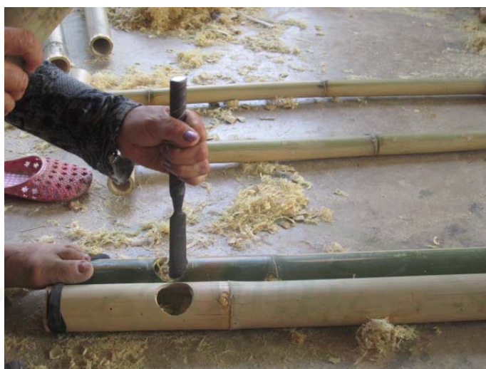
ภาพผนวกที่ 12 การตกแต่งรูด้วยสว่าน ที่มา: จากการสำรวจ
