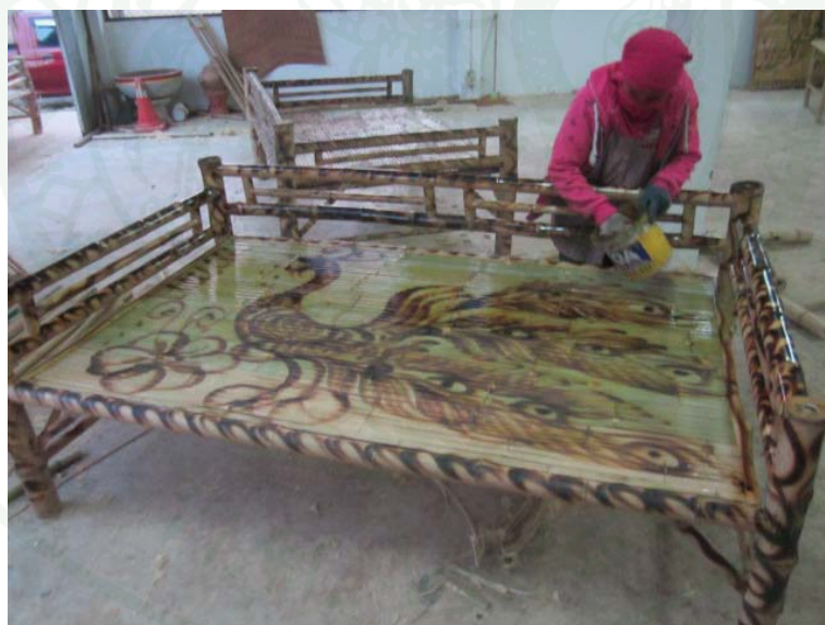
ภาพผนวกที่ 18 การทาน้ำมันเคลือบเงา ที่มา: จากการสำรวจ
