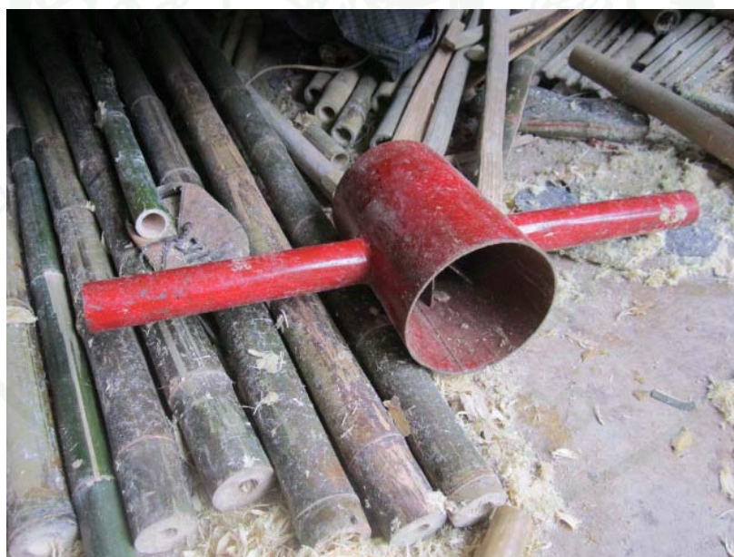
ภาพผนวกที่ 6 เครื่องผ่ารวไม้จากภูมิปัญญาชาวบ้าน ที่มา: จากการสำรวจ
