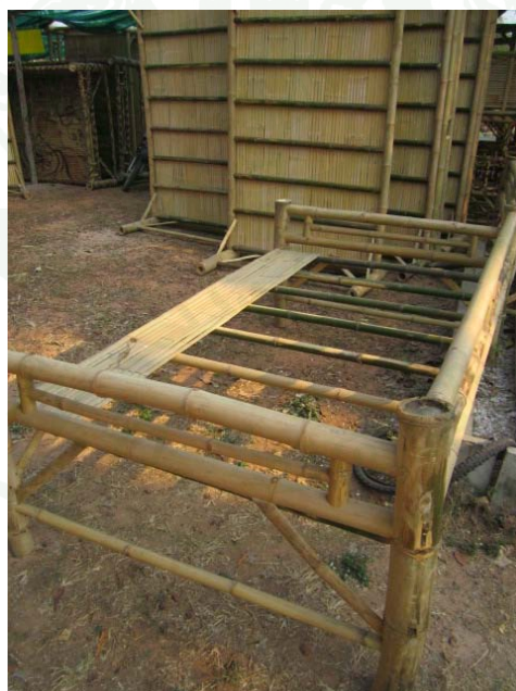
ภาพผนวกที่ 15 การตอกรวีไม้เข้ากับโครงสร้างที่ประกอบไว้ ที่มา: จากการสำรวจ
