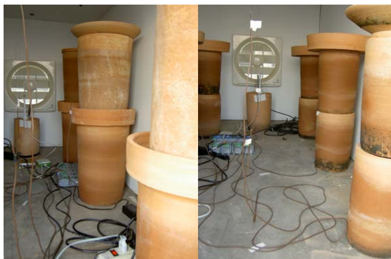
รูปที่ 4.26 การติดตั้งเครื่องปั้นดินเผา ชุดBในห้องทดลอง (ซ้าย) และชุดA ในห้องควบคุม (ขวา)
