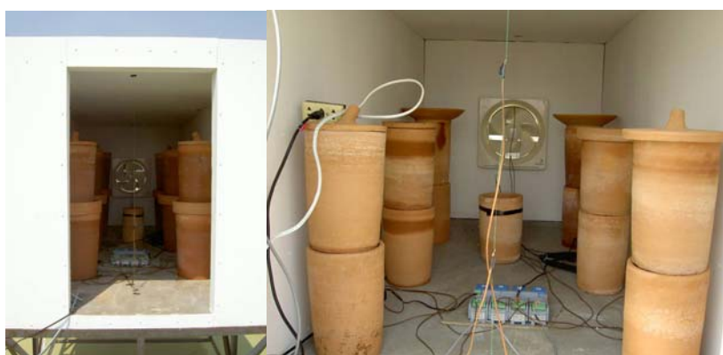
รูปที่ 4.8 แสดงการติดตั้งภาชนะดินเผาขนาดเล็กและขนาดใหญ่ในห้องทดลองทั้งสองห้อง
