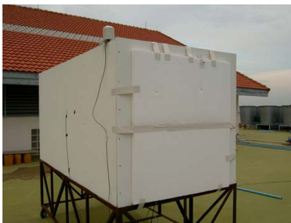
รูปที่ 4.19 ลักษณะห้องทดลองที่ปิดทางเข้าลมด้วยฉนวนโฟม
