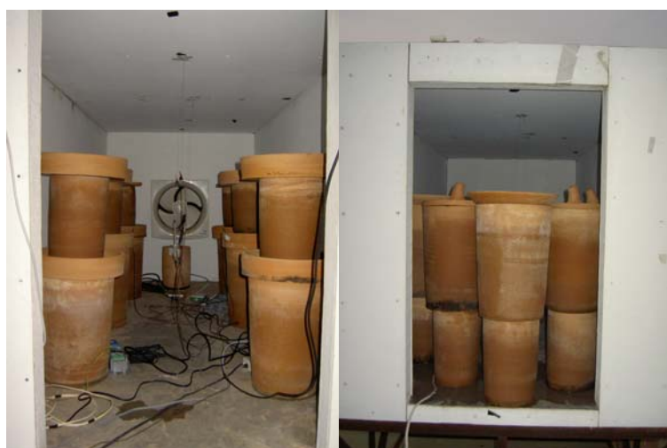
รูปที่ 4.38 ภาพแสดงการติดตั้งชุดเครื่องปั่นดินเผา ในแบบขนานลม (ซ้าย) และขวางทางลม (ขวา)
