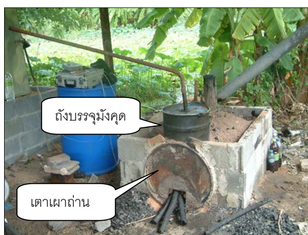
ภาพที่ 4.2 การทดสอบเตาผลิตน้ำส้มควันไม้จากมังคุด
