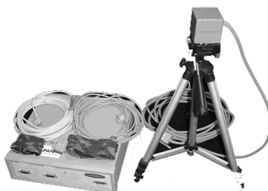
รูปที่ 3.22 อุปกรณ์ตรวจวัดตำแหน่งแบบ 6 แกนรุ่น 3SPACE® ISOTRAK II™ พร้อมด้วยเซนเซอร์ 2 ตัว และ Transmitter
