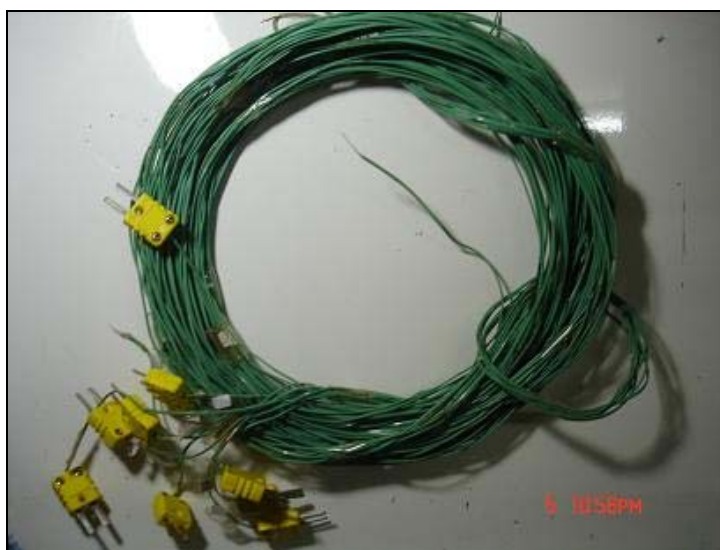
ภาพที่ 12 ชุดหัวต่อกับสายเทอร์โมคอปเปิลชนิด K ที่ใช้ในการทดลอง
