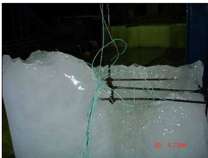
ภาพที่ 14 ลักษณะน้ำแข็งของหลังการผลิตที่ประกอบกับชุดวัดอุณหภูมิก่อนการเก็บชุดอุปกรณ์วัดสัญญาณ
