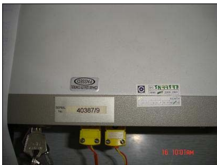
ภาพที่ 13 ชุดวัดสัญญาณอุณหภูมิที่ประกอบหัวต่อกับเครื่องวัดอุณหภูมิที่ใช้ในการทดลอง
