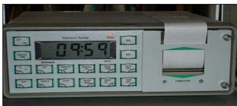
ภาพที่ 11 เครื่องบันทึกอุณหภูมิแบบ 10 ช่องสัญญาณ Comark รุ่น C 8510 ที่ใช้ในการทดลอง
