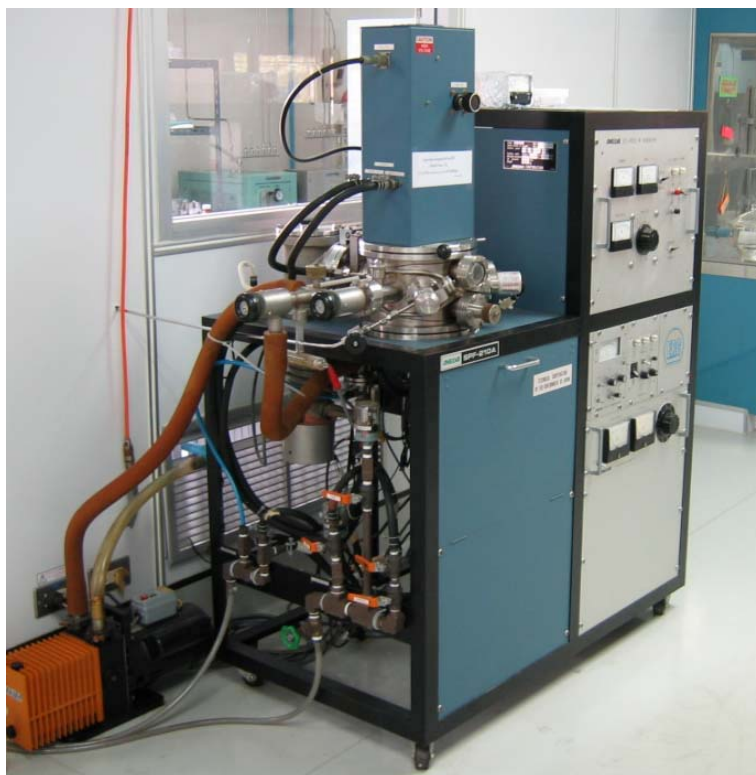
รูปที่ 4.14 ภาพถ่ายเครื่องสปีเตอร์ริงแบบ อาร์เอฟ สปีเตอร์ริง (ศูนย์วิจัยอิเล็กทรอนิกส์)
