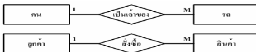
ภาพที่ ก.19 รูปแสดงตัวอย่างความสัมพันธ์แบบหนึ่งต่อกลุ่ม
