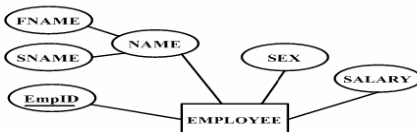
ภาพที่ ก.12 รูปตัวอย่างการแสดง Identifier/Key ใน E-R Diagram
