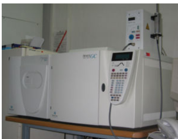
รูปที่ 2.27 เครื่อง Gas Chromatography-Mass Spectrometry [26]
