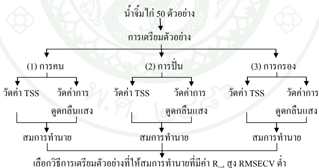
ภาพที่ 11 ขั้นตอนการศึกษาวิธีเตรียมตัวอย่างน้ำจิ้มไก่ที่เหมาะสมในการวัดค่าการดูดกลืนแสงจากเครื่อง NIR
