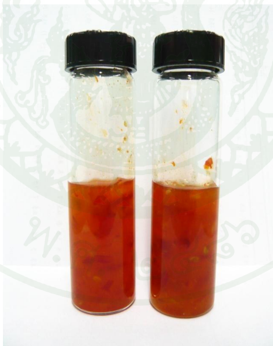
ภาพผนวกที่ ง1 ตัวอย่างน้ำจิ้มไก่ที่บรรจุในหลอดทดลอง ก่อนนำไปควบคุมให้มีอุณหภูมิ 25 องศาเซลเซียสใน Water bath
