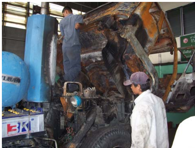
ภาพที่ 15 ภาพรถบรรทุกคอนกรีตผสมเสร็จไฟไหม้
