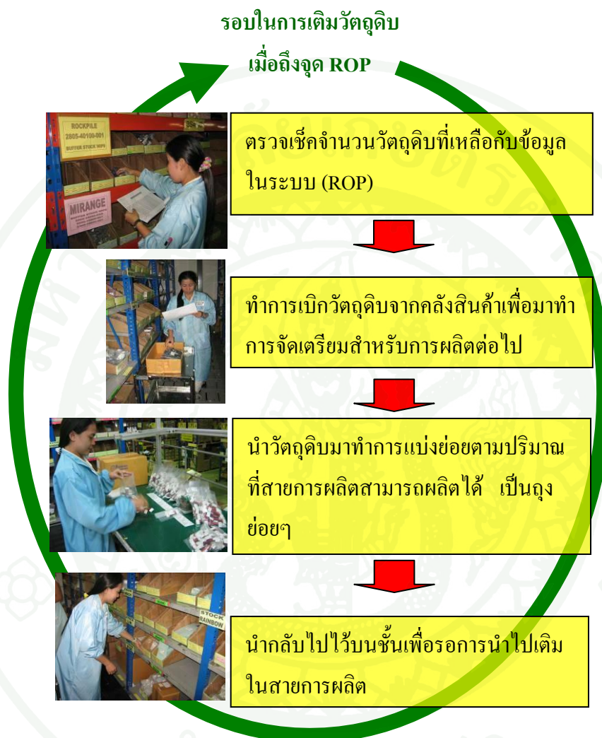
ภาพที่ 23 แสดงวิธีการเติมวัตถุดิบเมื่อถึงจุด ROP
