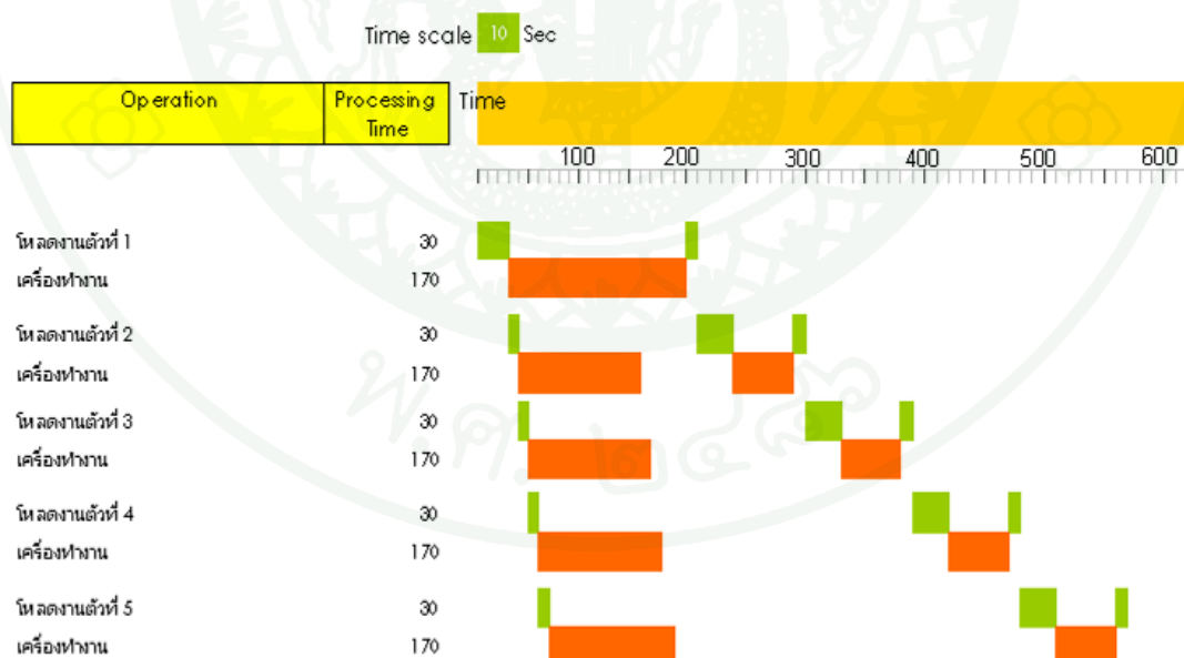
ภาพที่ 42 กราฟแสดงเวลาการทำงานของเครื่องจักรสำหรับทดสอบ System Test
