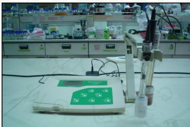
ภาพผนวกที่ ก3 เครื่อง pH / Ion 510 สำหรับวัดค่าความเป็นกรด-เบส และค่า ORP
