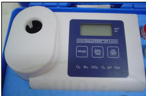
ภาพผนวกที่ ก2 เครื่อง Dulcotest DT1 Photometer สำหรับวัดสีของการทำปฏิกิริยาของ DPD Tablet กับน้ำล้างกลุ่มออกซิไดส์ซิง
