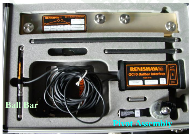
ภาพที่ 8 ชุดอุปกรณ์บอล-บาร์ Renishaw Ball Bar QC10
