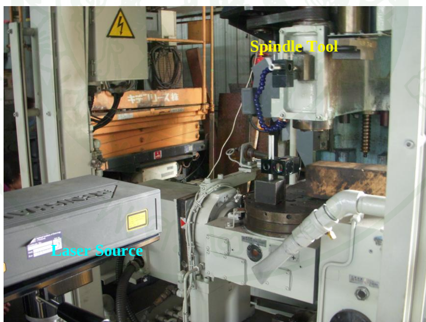
ภาพที่ 11 การติดตั้งเลเซอร์อินเตอร์เฟียโรมิเตอร์ เพื่อวัดค่าความผิดพลาดทางการเคลื่อนที่ใน แนวแกน Z
