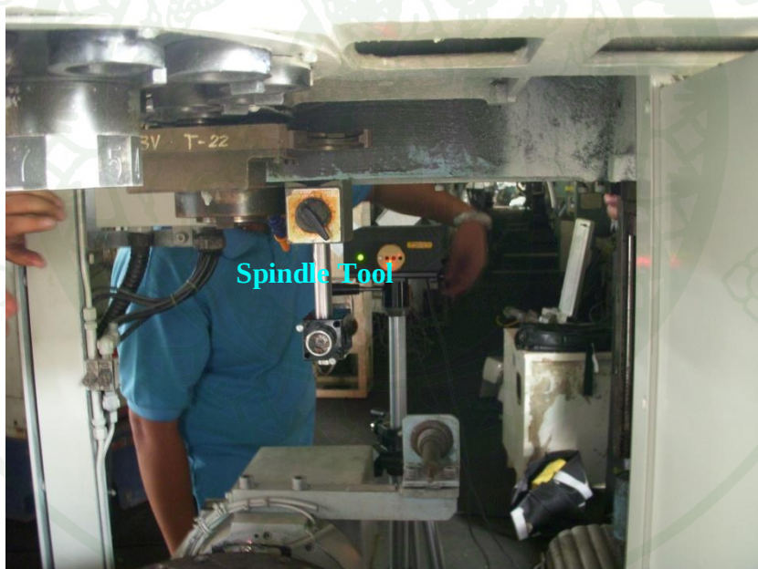
ภาพที่ 9 การติดตั้งเลเซอร์อินเตอร์เฟียโรมิเตอร์ เพื่อวัดค่าความผิดพลาดทางการเคลื่อนที่ในแนวแกน X
