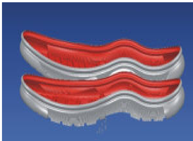
ภาพที่ 48 จัดวางตำแหน่งของชิ้นงาน (Mold layout)
