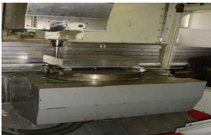
ภาพที่ 124 การขึ้นรูปพื้นรองเท้าของแม่พิมพ์โดยตรงบนชิ้นงานอะลูมิเนียม
