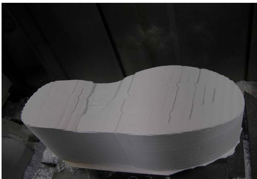
ภาพที่ 113 การขึ้นรูปชิ้นงานแบบไม้บนเครื่องกัดห้าแกน
