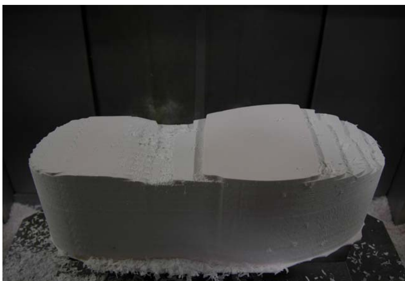
ภาพที่ 112 การขึ้นรูปชิ้นงานแบบไม้บนเครื่องกัดห้าแกน
