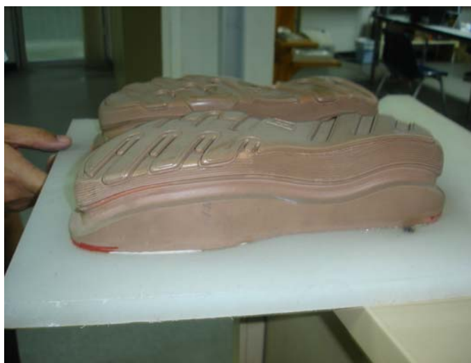
ภาพที่ 15 แบบงานหล่อ (Pattern) หรือ Wood Model ของบริษัทซีเคเอสโมลด์
