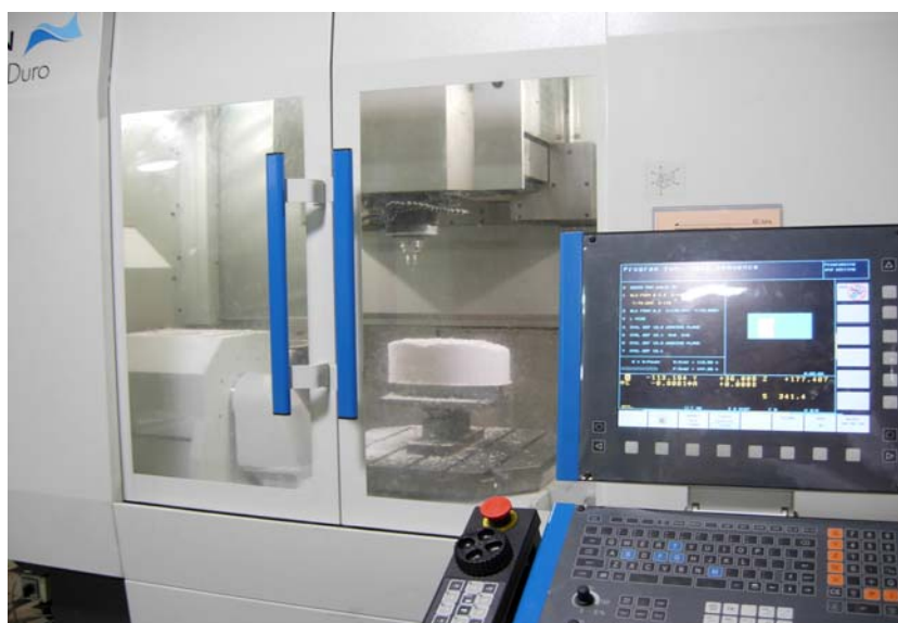
ภาพที่ 110 การขึ้นรูปชิ้นงานแบบไม้บนเครื่องกัดห้าแกน
