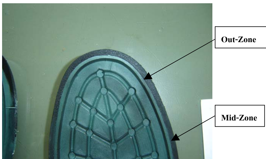
ภาพที่ 7 ตัวอย่างของชิ้นงานที่วัสดุ 2 ชนิด ของบริษัทซีเคเอสโมลด์
