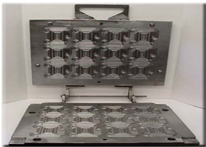
ภาพที่ 2 ตัวอย่างแม่พิมพ์ยางแบบอัดขึ้นรูป (Station Industries)
