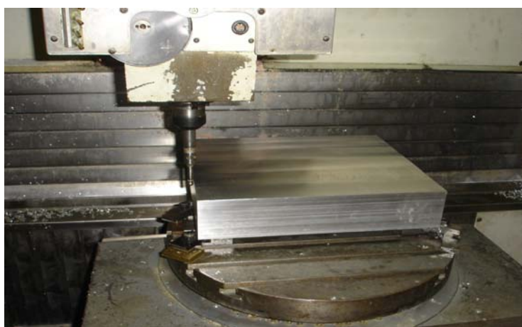
ภาพที่ 122 การเตรียมวัตถุดิบเพื่อจะนำมากัดพื้นรองเท้าของแม่พิมพ์โดยตรงบนชิ้นงานอะลูมิเนียม
