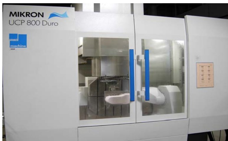
ภาพที่ 117 การขึ้นรูปชิ้นงานแบบไม้บนเครื่องกัดห้าแกน
