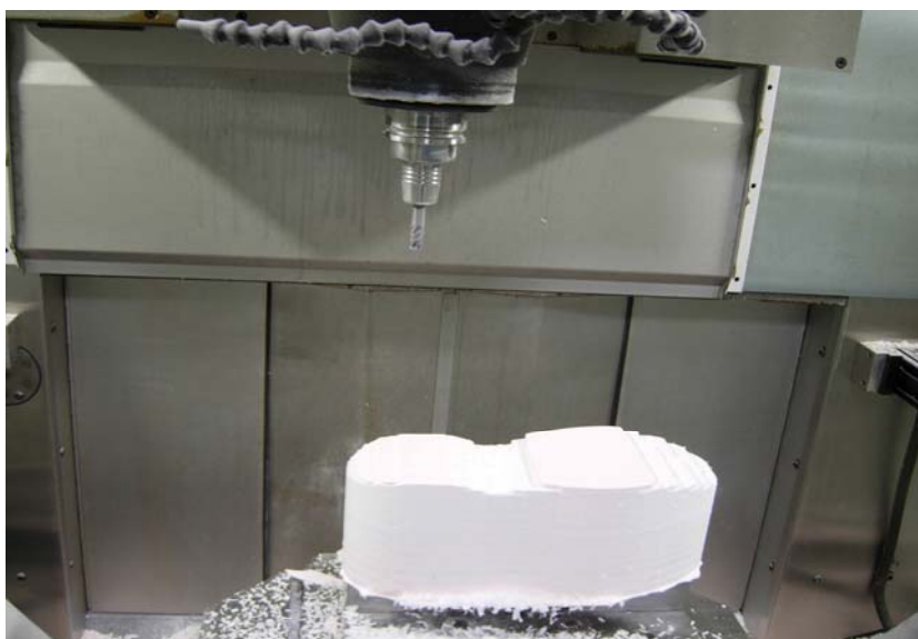
ภาพที่ 111 การขึ้นรูปชิ้นงานแบบไม้บนเครื่องกัดห้าแกน
