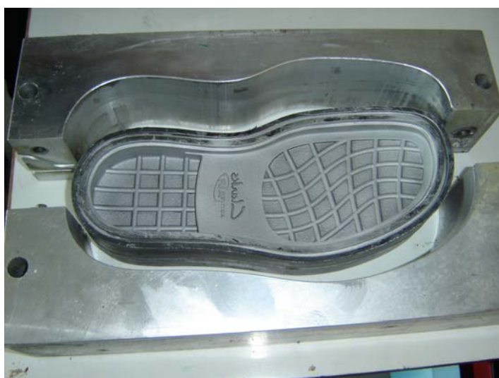
ภาพที่ 11 แม่พิมพ์พื้นรองเท้าส่วน Out-Zone ของบริษัทซีเคเอสโมลด์
