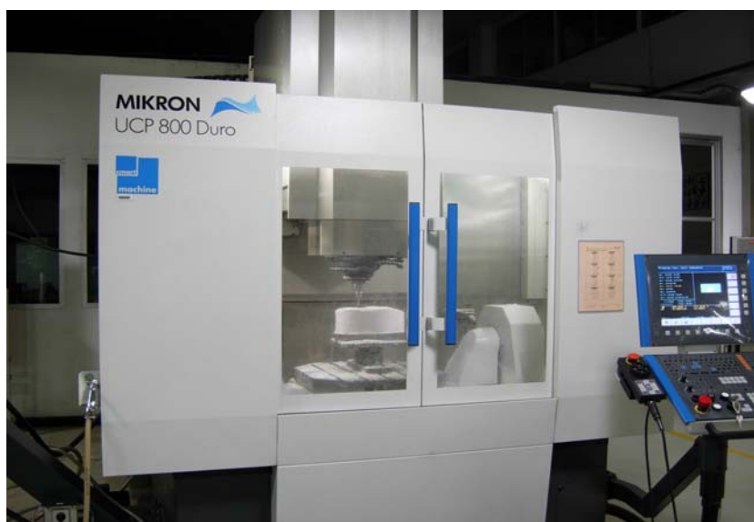
ภาพที่ 109 การขึ้นรูปชิ้นงานแบบไม้บนเครื่องกัดห้าแกน
