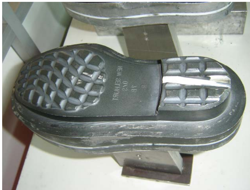
ภาพที่ 12 แม่พิมพ์พื้นรองเท้าส่วน Mid-Zone ของบริษัทซีเคเอสโมลด์
