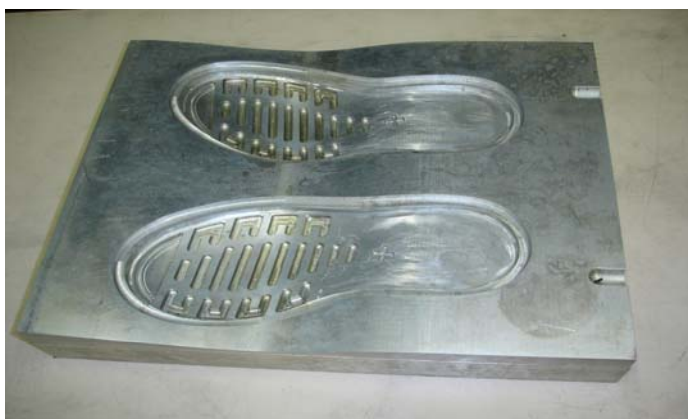
ภาพที่ 125 ผลการขึ้นรูปพื้นรองเท้าของแม่พิมพ์โดยตรงบนชิ้นงานอะลูมิเนียม
