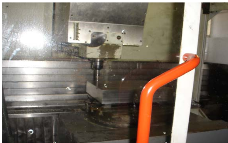
ภาพที่ 123 การปรับตั้งชิ้นงานเพื่อจะนำมากัดพื้นรองเท้าของแม่พิมพ์โดยตรงบนชิ้นงานอะลูมิเนียม
