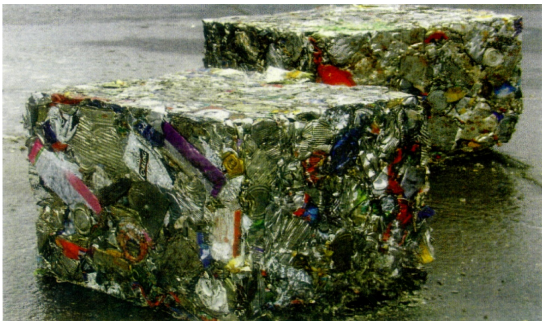
ภาพผนวกที่ ก5 เศษเหล็กกลุ่ม 3 ส่วนที่ 2 ได้แก่ ลูกอัดกระป๋อง (โดยปกติจะมีดินบุกและ โครเมียมเคลือบอยู่บ้าง)
