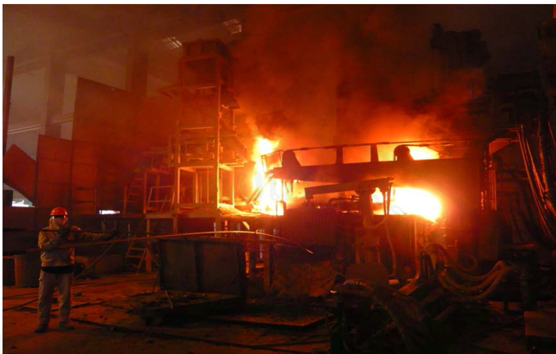
ภาพผนวกที่ ข1 การฟั่นออกซิเจนเข้าเตาหลอมไฟฟ้า (EAF)
