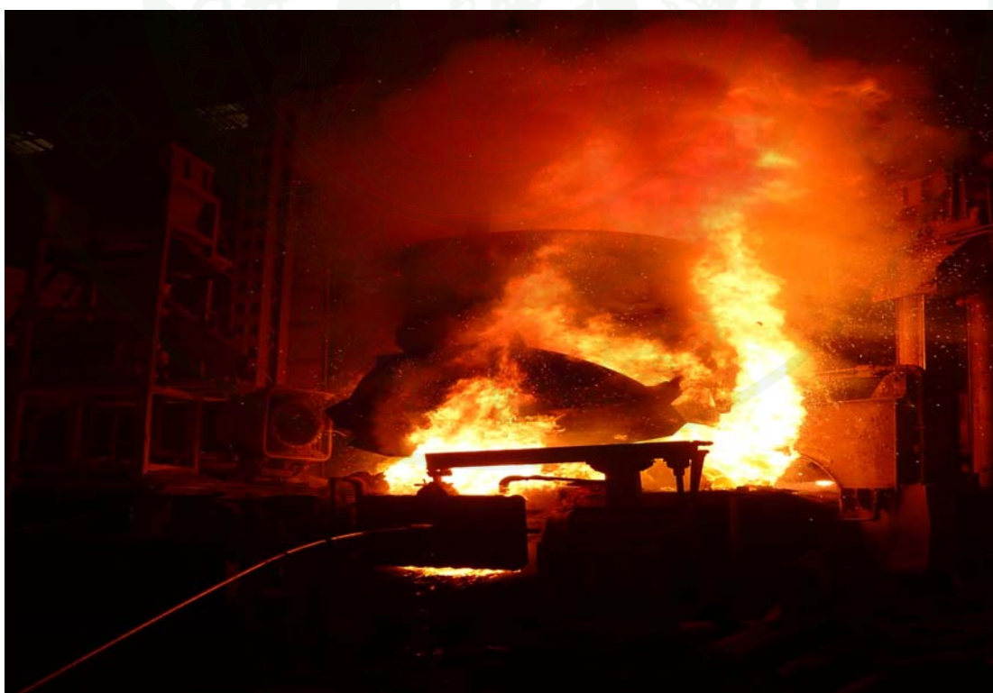
ภาพผนวกที่ ข2 การเติมเศษเหล็กเข้าเตาหลอมไฟฟ้า (EAF)
