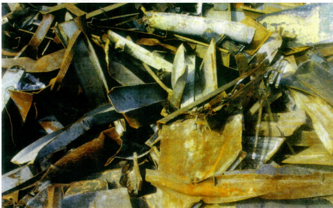
ภาพผนวกที่ ก2 เศษเหล็กกลุ่ม 2 ส่วนที่ 1 ได้แก่ แผ่นปี้มบาง แผ่นปี้มดำ เหล็กตัดไฟ ลูกอัดปี้มหนา ลูกอัดปี้มดำ เหล็ก Return
