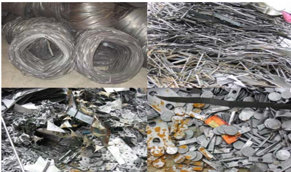
ภาพผนวกที่ ก3 เศษเหล็กกลุ่ม 2 ส่วนที่ 2 ได้แก่ เหล็กตัดขอบจากเหล็กแผ่นรีดเย็น เหล็กตะเกียบจากเหล็กแผ่นรีดร้อน เหล็กป้อน เหล็กป้อนดำ
