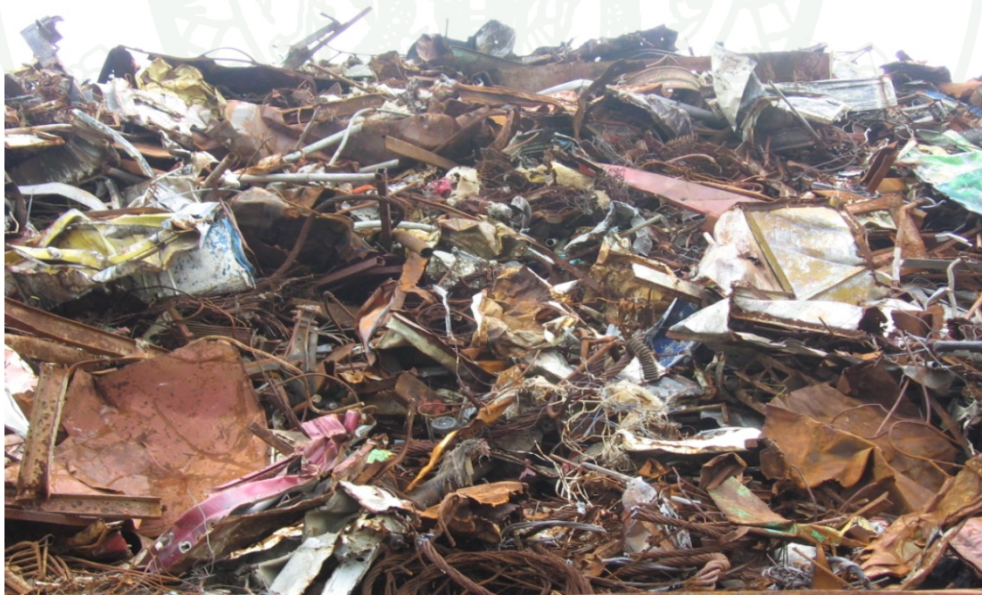
ภาพผนวกที่ ก4 เศษเหล็กกลุ่ม 3 ส่วนที่ 1 ได้แก่ แผ่นสังกะสีป้อน Tin Plate ลูกอัดกระป๋อง ลูกอัดแผ่นสังกะสี
