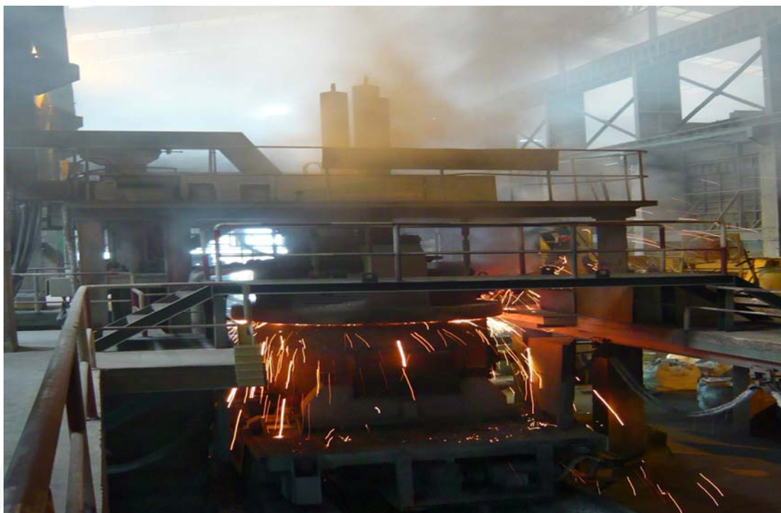
ภาพผนวกที่ ข3 การอาร์คต่อในเตาปรับปรุงคุณภาพน้ำเหล็ก (LF)
