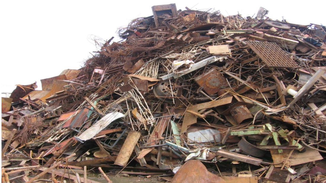
ภาพผนวกที่ ก1 เศษเหล็กกลุ่ม 1 ได้แก่ แผ่นสังกะสีปี้ม Tin Free ลูกอัดบาง ลูกอัดแผ่นสังกะสีปี้ม Tin Free ลูกอัดเส้นลวด ลูกอัดสายรัด
