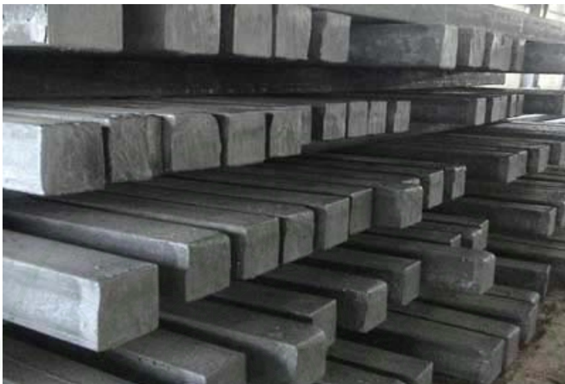
ภาพผนวกที่ ค1 ผลิตภัณฑ์เหล็กกึ่งสำเร็จรูป (Semi-Finished Products) คือ เหล็กแท่ง (Billets)
