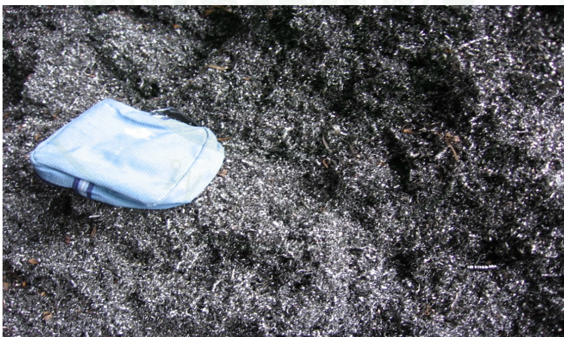
ภาพผนวกที่ ก6 เศษเหล็กกลุ่ม 4 ได้แก่ จั๊กลิงเหล็กเหนียว จี้เลื่อยเหล็กเหนียว เหล็กยิงทราย (Shot Peening) เศษน้ำเหล็ก
