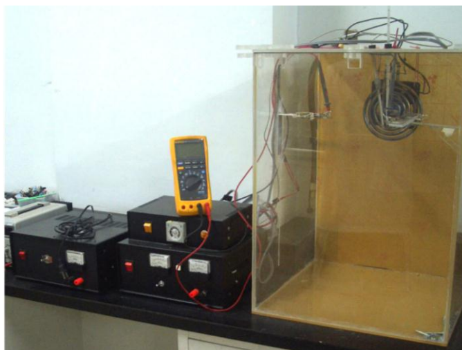
รูปที่ 3.3 เครื่องวัดสภาพการนำไฟฟ้าสัมพันธ์กับอุณหภูมิ
